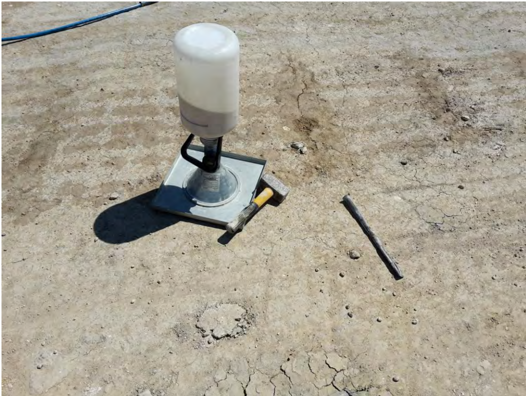
Prova di densità in situ D63 del 22/04/2015
