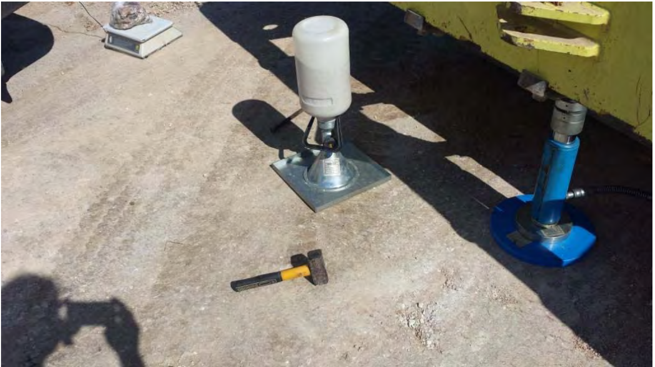
Prova di densità in situ D20 del 08/10/2014
