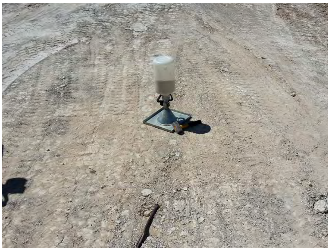
Prova di densità in situ D58 del 15/04/2015
