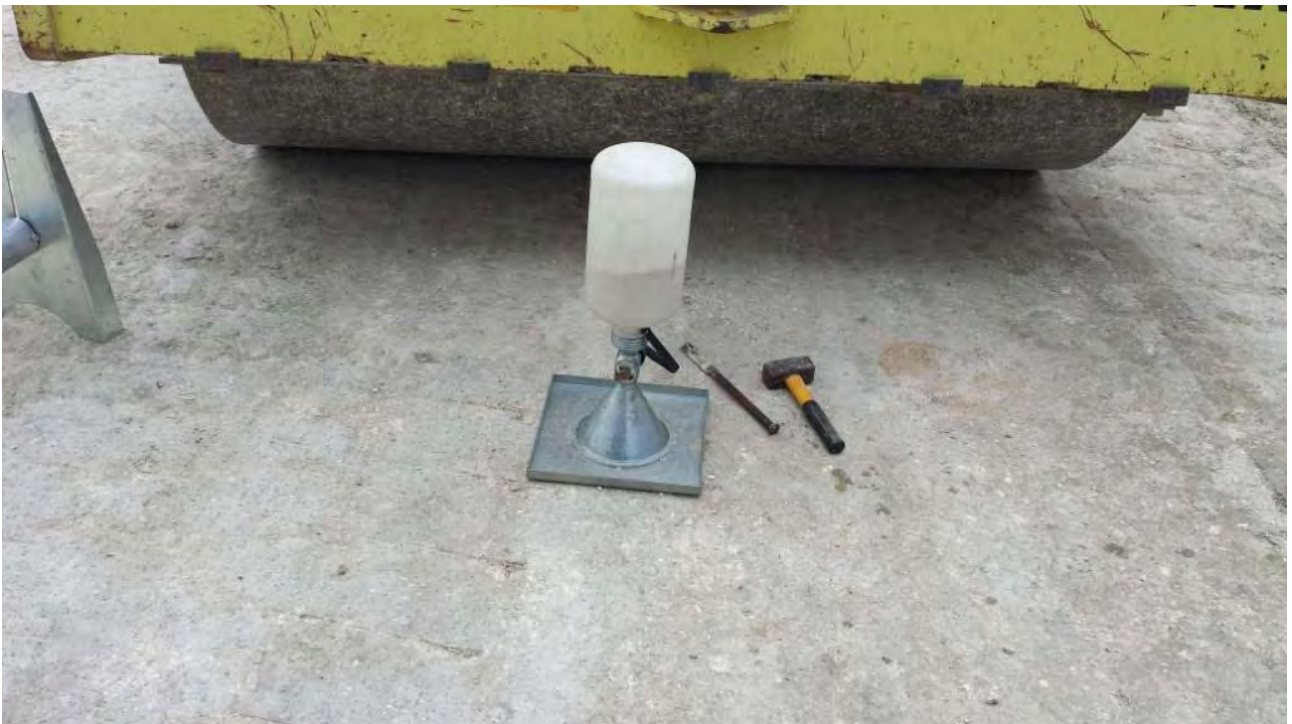
Prova di densità in situ D34 del 27/10/2014
