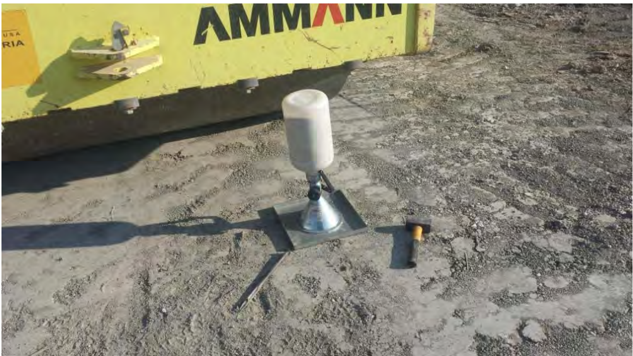
Prova di densità in situ D29 del 08/10/2014
