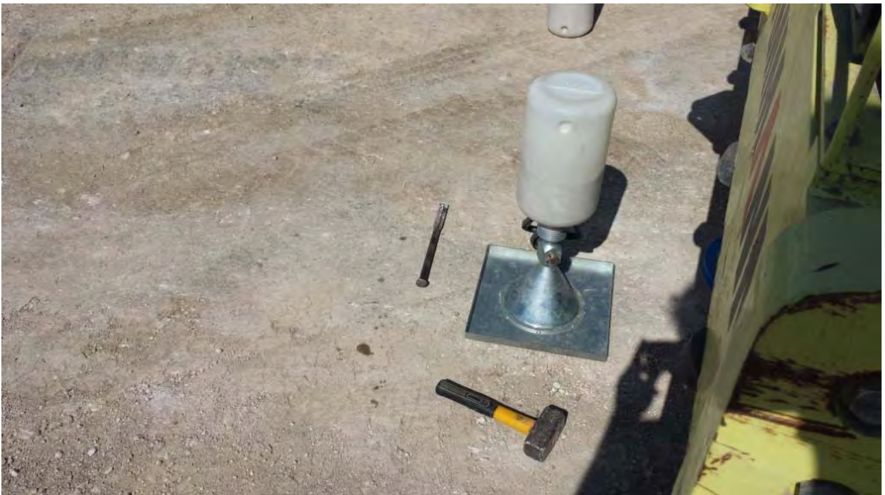
Prova di densità in situ D20 del 08/10/2014
