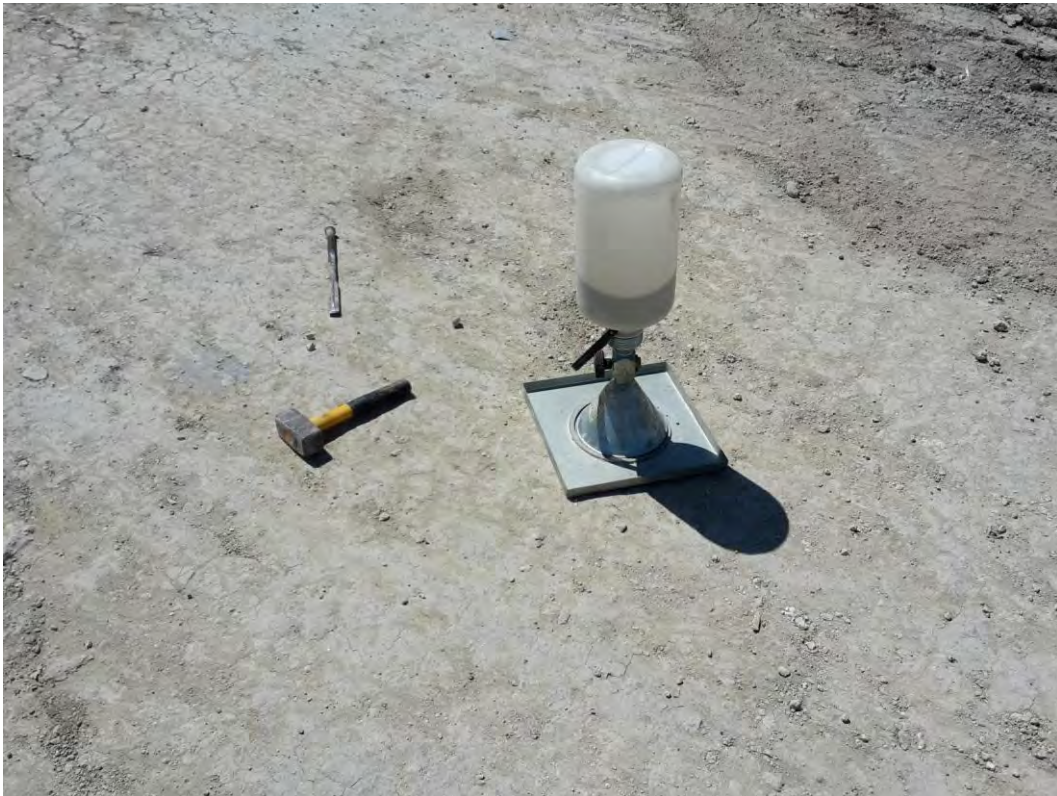
Prova di densità in situ D66 del 22/04/2015
