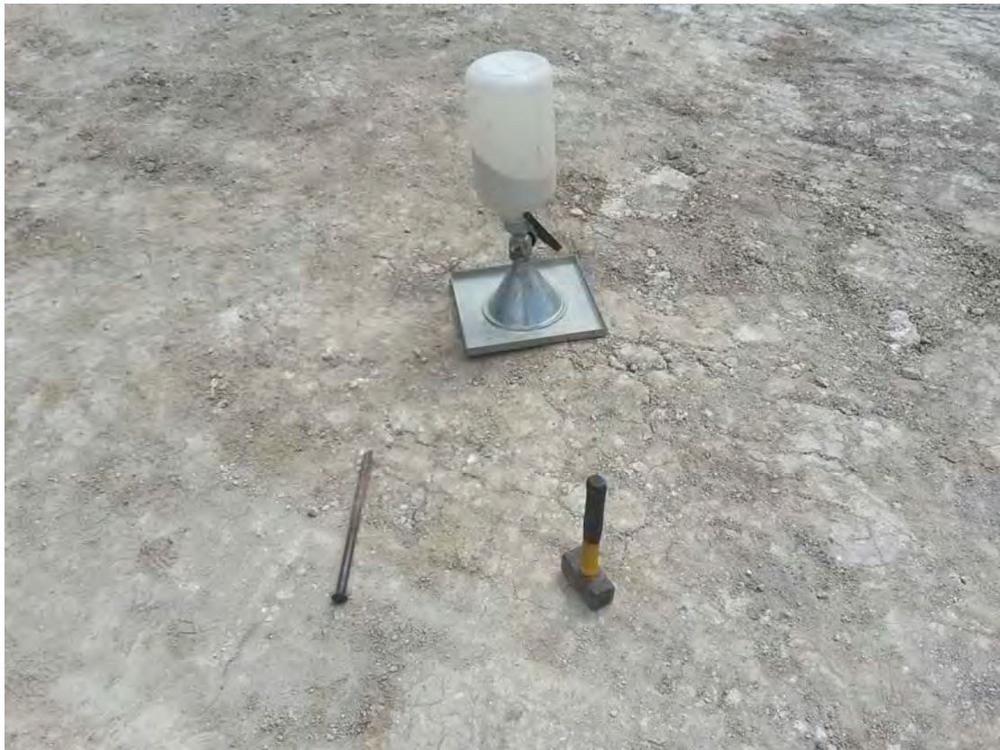
Prova di densità in situ D51 del 10/04/2015
