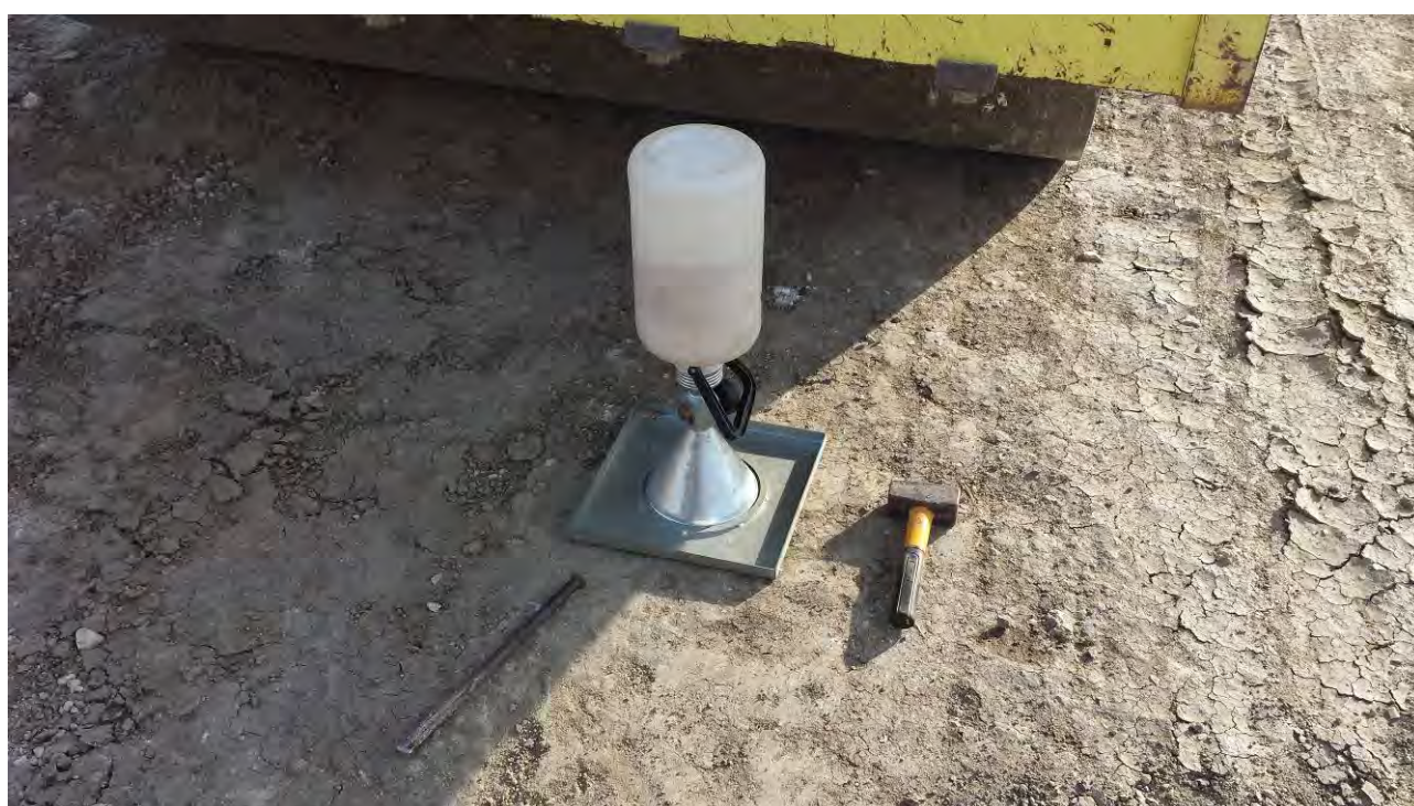
Prova di densità in situ 13 del 24/09/2014
