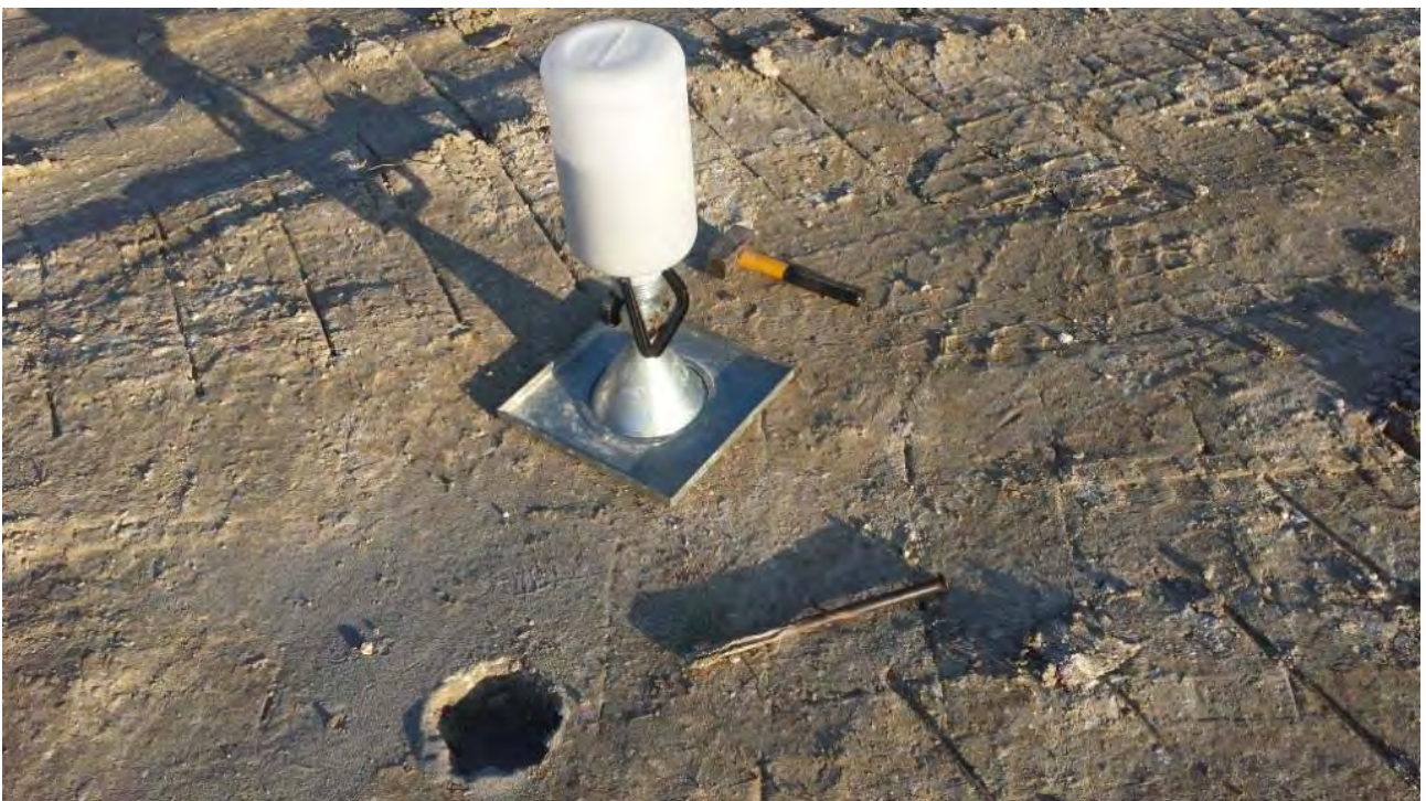
Prova di densità in situ D42 del 19/11/2014
