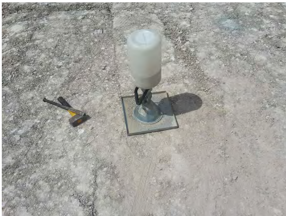
Prova di densità in situ D54 del 10/04/2015
