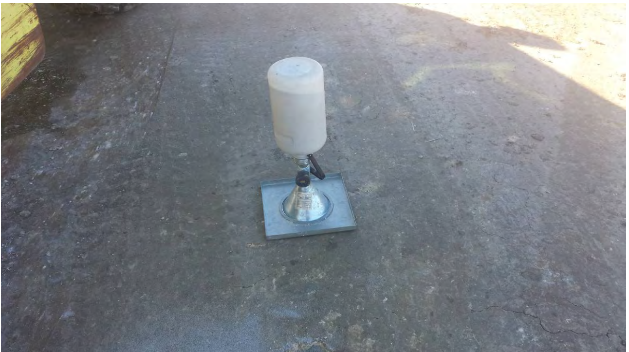
Prova di densità in situ D50 del 23/12/2014
