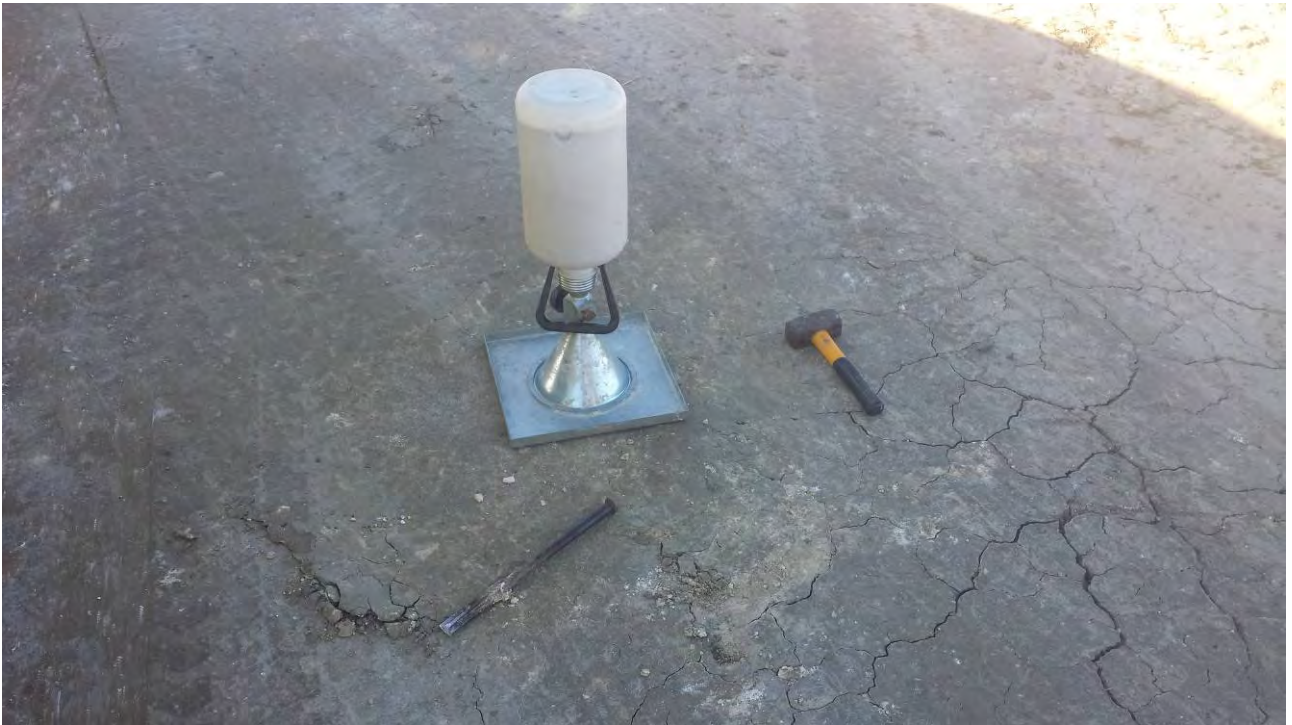
Prova di densità in situ D50 del 23/12/2014
