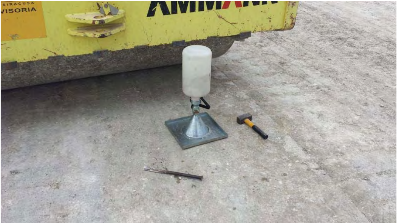
Prova di densità in situ D34 del 27/10/2014
