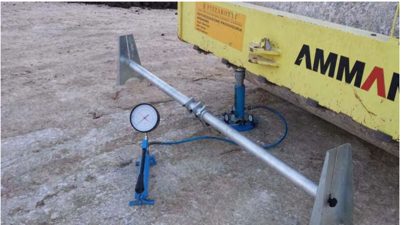
Prova carico Pc21 del 19/11/2014
