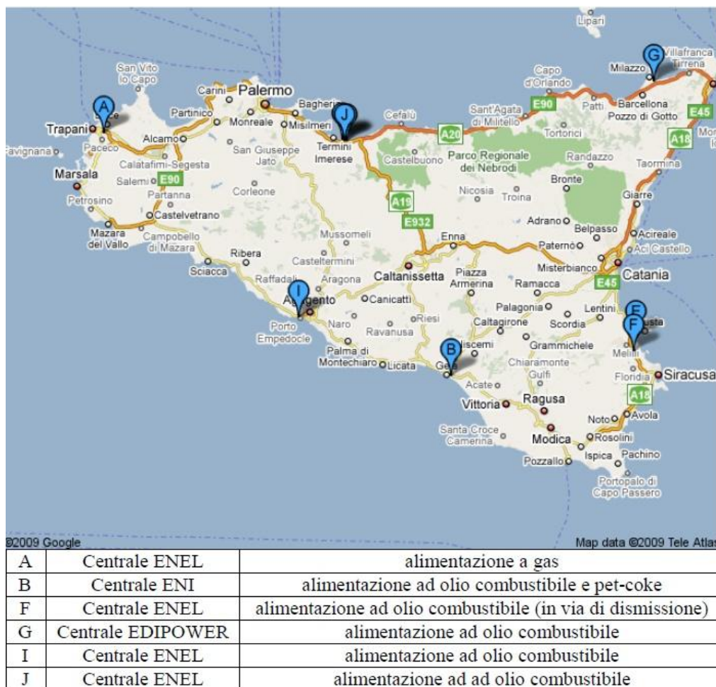
Figura 17 Dislocazione e caratteristiche delle centrali termoelettriche.
