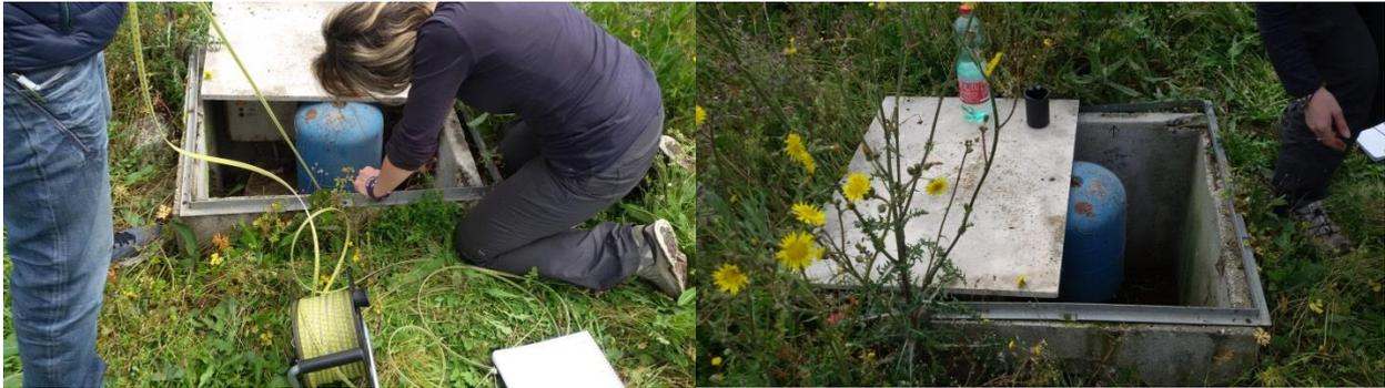
Figura 11-3 *Misura livello statico su pozzo.*
