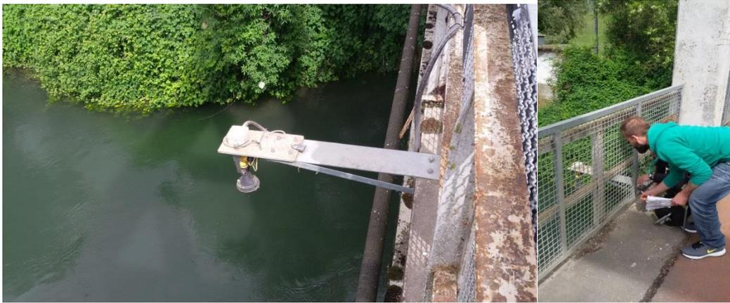
**Figura 11-8 Misura della quota del pelo d'acqua sul Fiume Velino in corrispondenza del Ponte di Terria.**
