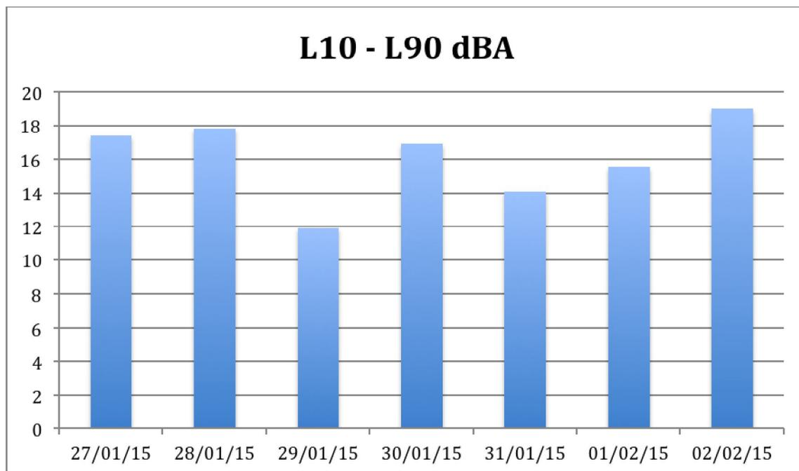
La differenza L10 - L90 (riportata in dBA sull'asse y) rappresenta la variabilità dei valori rilevati nell'arco della misura.
