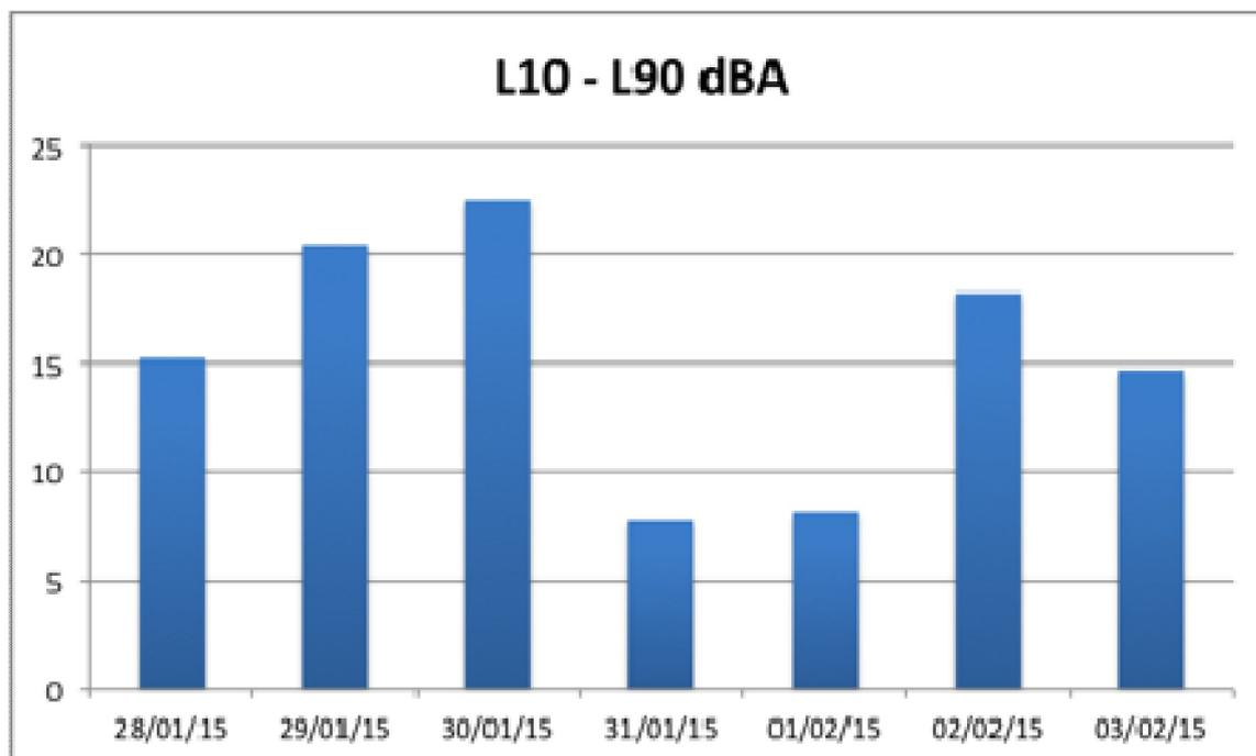
La differenza L10 - L90 (riportata in dBA sull'asse y) rappresenta la variabilità dei valori rilevati nell'arco della misura.
