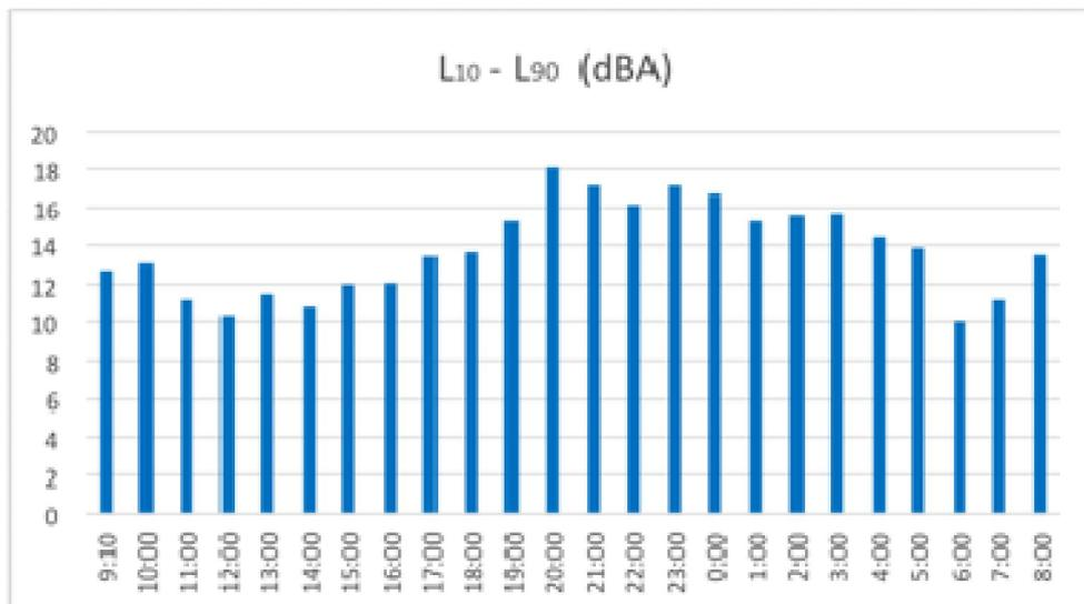
La differenza  $L_{10} - L_{90}$  (riportata in dBA sull'asse y) rappresenta la variabilità dei valori rilevati nell'arco della misura. Nel grafico sull'asse x si riportano i valori orari
