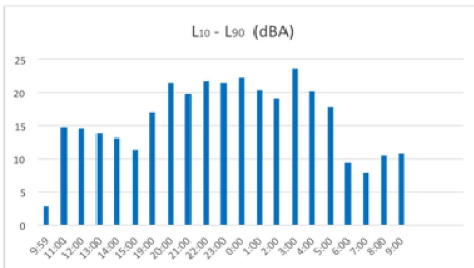
La differenza L10 - L90 (riportata in dBA sull'asse y) rappresenta la variabilità dei valori rilevati nell'arco della misura. Nel grafico sull'asse x si riportano i valori orari
