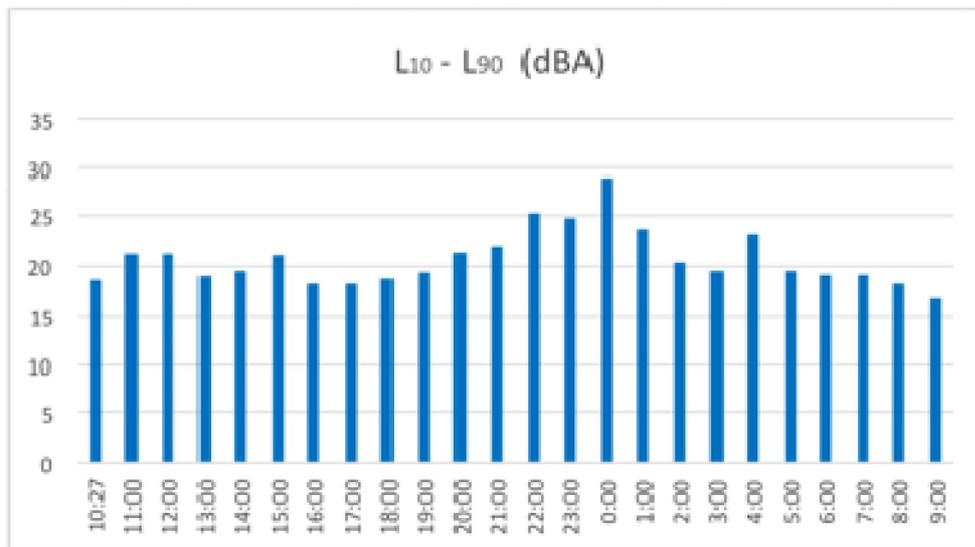
La differenza L<sub>10</sub> - L<sub>90</sub> (riportata in dBA sull'asse y) rappresenta la variabilità dei valori rilevati nell'arco della misura. Nel grafico sull'asse x si riportano i valori orari
