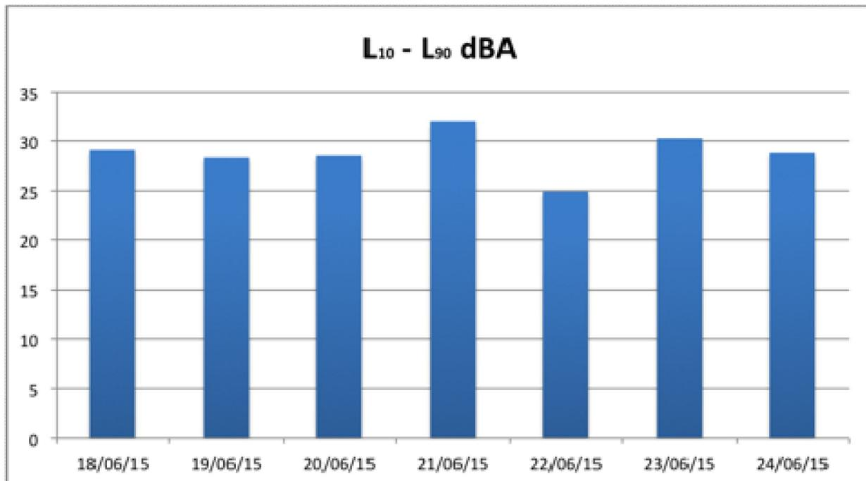
La differenza L<sub>10</sub> - L<sub>90</sub> (riportata in dBA sull'asse y) rappresenta la variabilità dei valori rilevati nell'arco della misura
