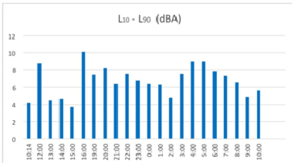
La differenza L<sub>10</sub> - L<sub>90</sub> (riportata in dBA sull'asse y) rappresenta la variabilità dei valori rilevati nell'arco della
