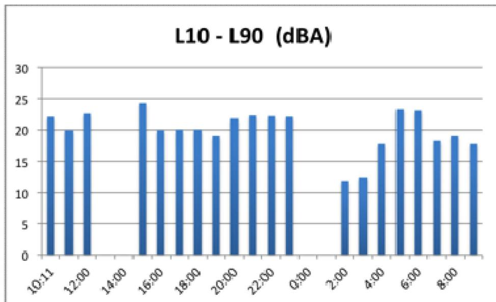
La differenza L10 - L90 (riportata in dBA sull'asse y) rappresenta la variabilità dei valori rilevati nell'arco della misura. Nel grafico sull'asse x si riportano i valori orari
