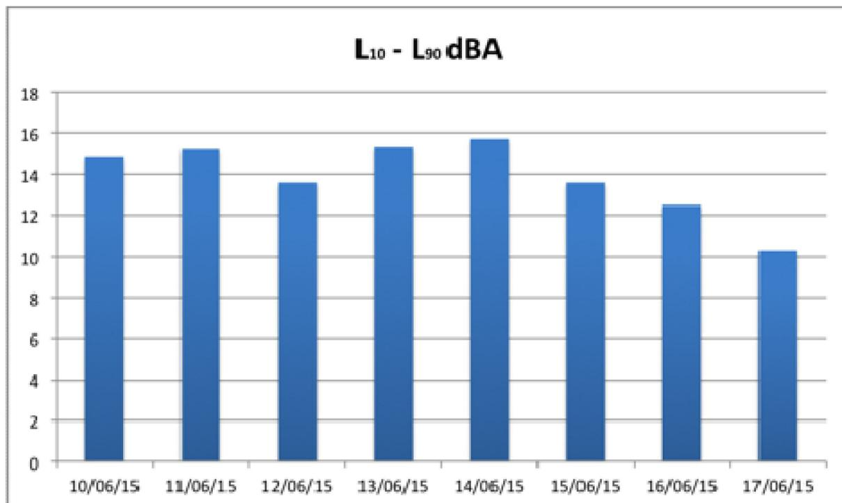
La differenza L<sub>10</sub> - L<sub>90</sub> (riportata in dBA sull'asse y) rappresenta la variabilità dei valori rilevati nell'arco della misura
