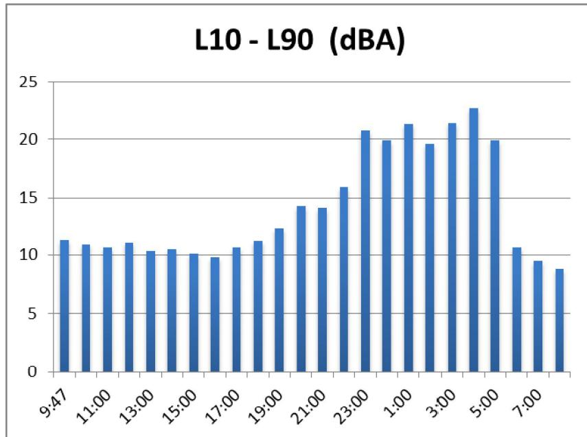
La differenza L10 - L90 (riportata in dBA sull'asse y) rappresenta la variabilità dei valori rilevati nell'arco della misura. Nel grafico sull'asse x si riportano i valori orari
