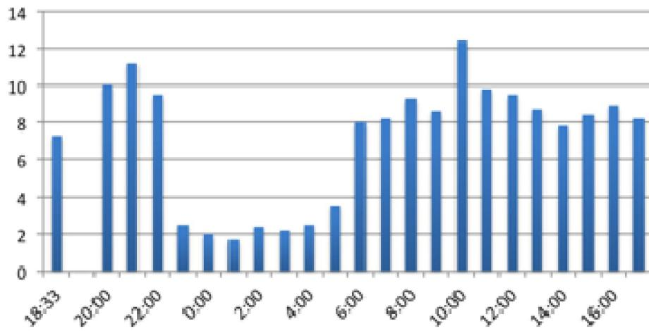
La differenza L10 - L90 (riportata in dBA sull'asse y) rappresenta la variabilità dei valori rilevati nell'arco della misura. Nel grafico sull'asse x si riportano i valori orari
