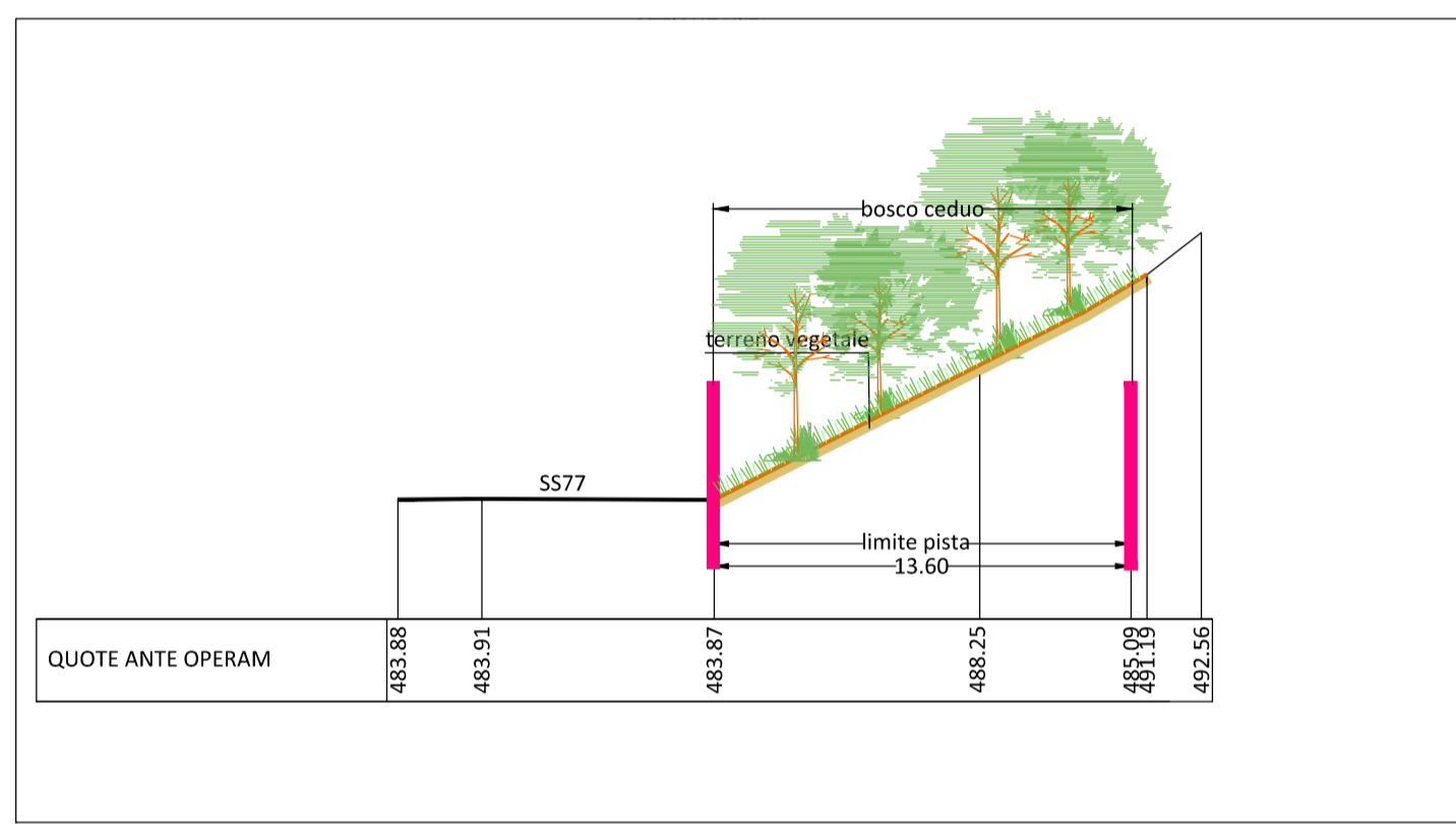
SEZIONE 1 - TIPO A - SCALA 1:250
