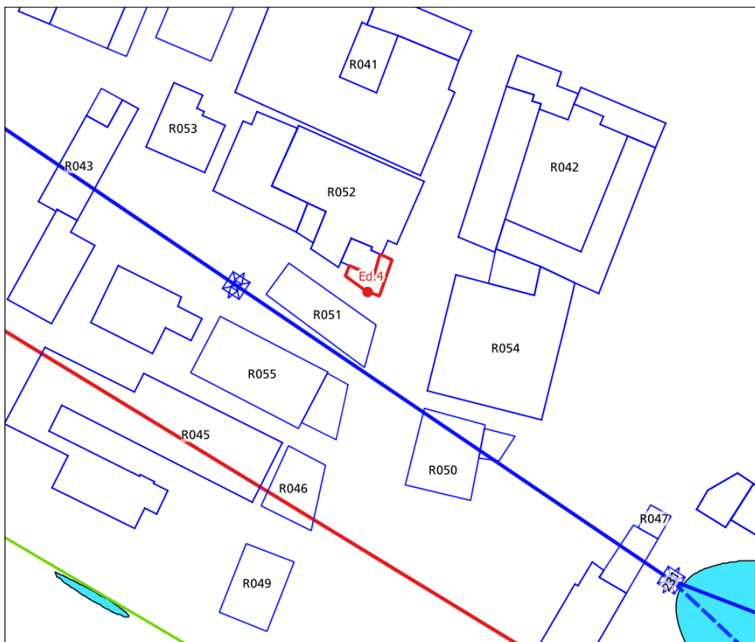
Figura 87: recettore ID 052 edificio 4 – scenario 1, curva isolivello dell'induzione magnetica a 3 \mu T alla quota di 57 m.
