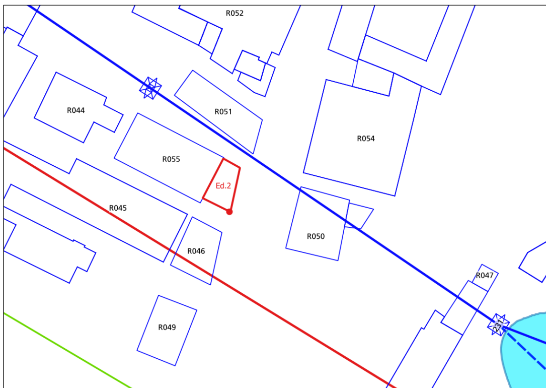
Figura 93: recettore ID 055 edificio 2 – scenario 4, curva isolivello dell'induzione magnetica a 3 \mu T alla quota di 57 m.
