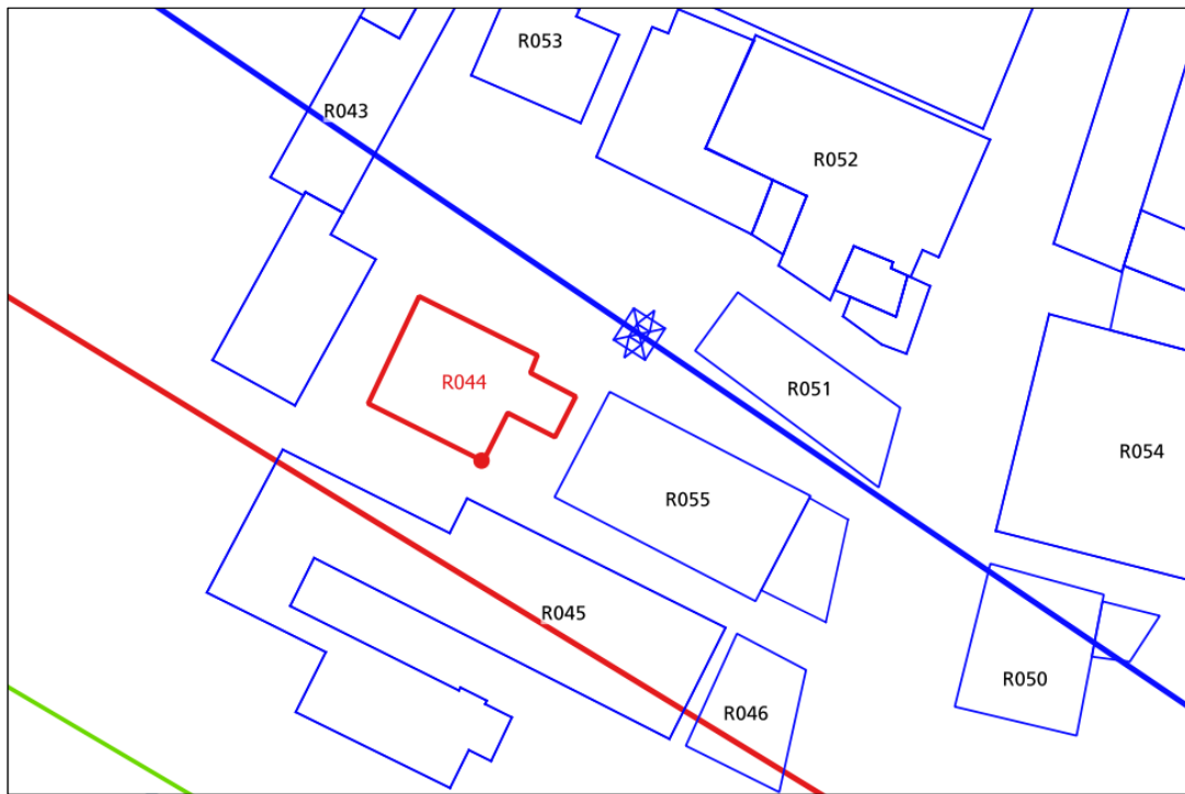
Figura 71: recettore ID 044 – scenario 4, curva isolivello dell'induzione magnetica a 3 \mu T alla quota di 60 m.
