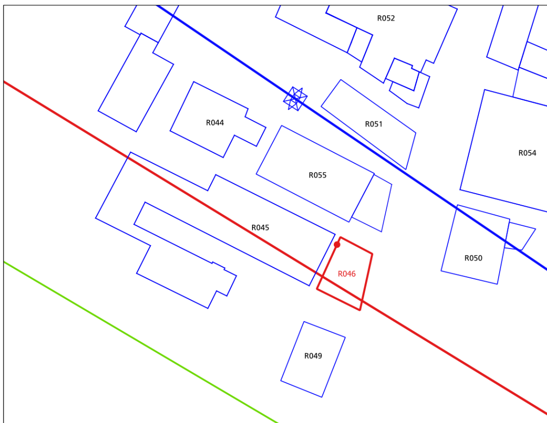
Figura 73: recettore ID 046 – scenario 4, curva isolivello dell'induzione magnetica a 3 \mu T alla quota di 57 m.
