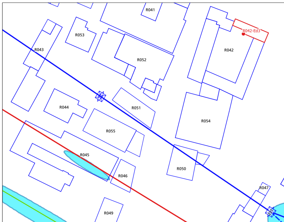
Figura 66: recettore ID 042 edificio 3 – scenario 1, curva isolivello dell'induzione magnetica a 3 \mu T alla quota di 61 m.
