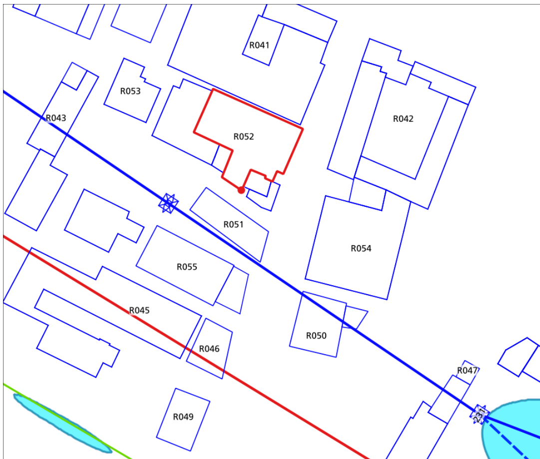
Figura 88: recettore ID 052 edificio 5 – scenario 1, curva isolivello dell'induzione magnetica a 3 \mu T alla quota di 57,5 m.
