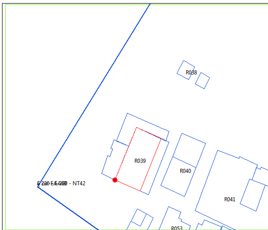
Figura 58: recettore ID 039 edificio 3 – scenario 1, curva isolivello dell'induzione magnetica a 3 \mu T alla quota di 59,5 m.
