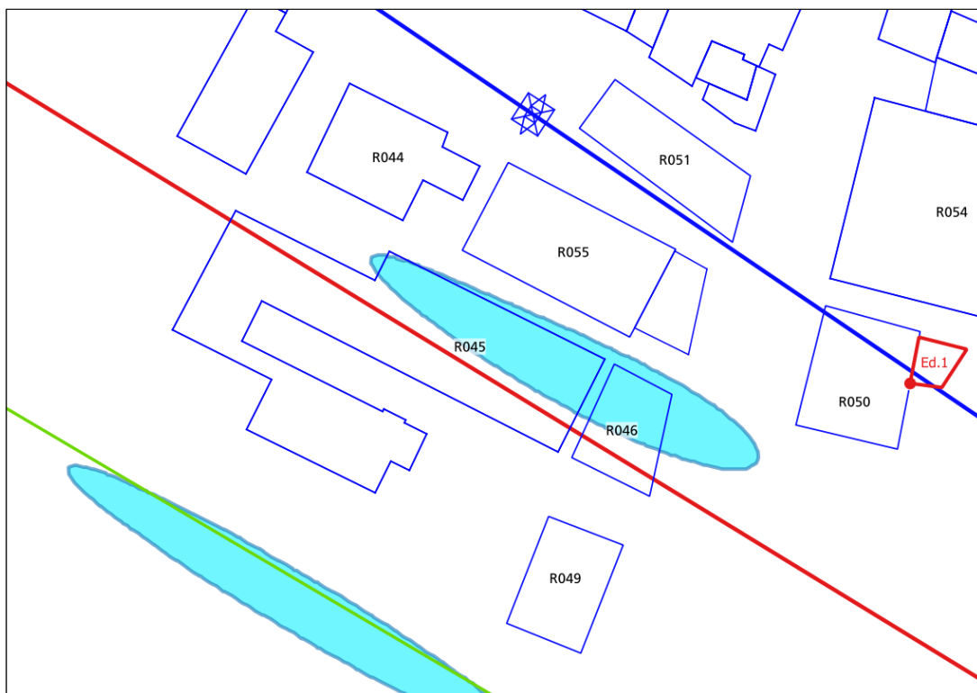
Figura 81: recettore ID 050 edificio 1 – scenario 4, curva isolivello dell'induzione magnetica a 3 \mu T alla quota di 61 m.
