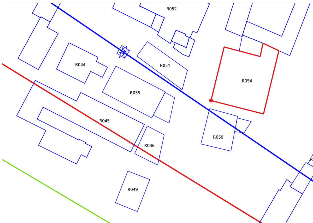
Figura 91: recettore ID 054 edificio 2 –scenario 4, curva isolivello dell'induzione magnetica a 3 \mu T alla quota di 57,5 m.
