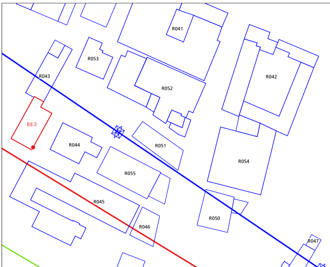
Figura 70: recettore ID 043 edificio 3 – scenario 4, curva isolivello dell'induzione magnetica a 3 \mu T alla quota di 59 m.
