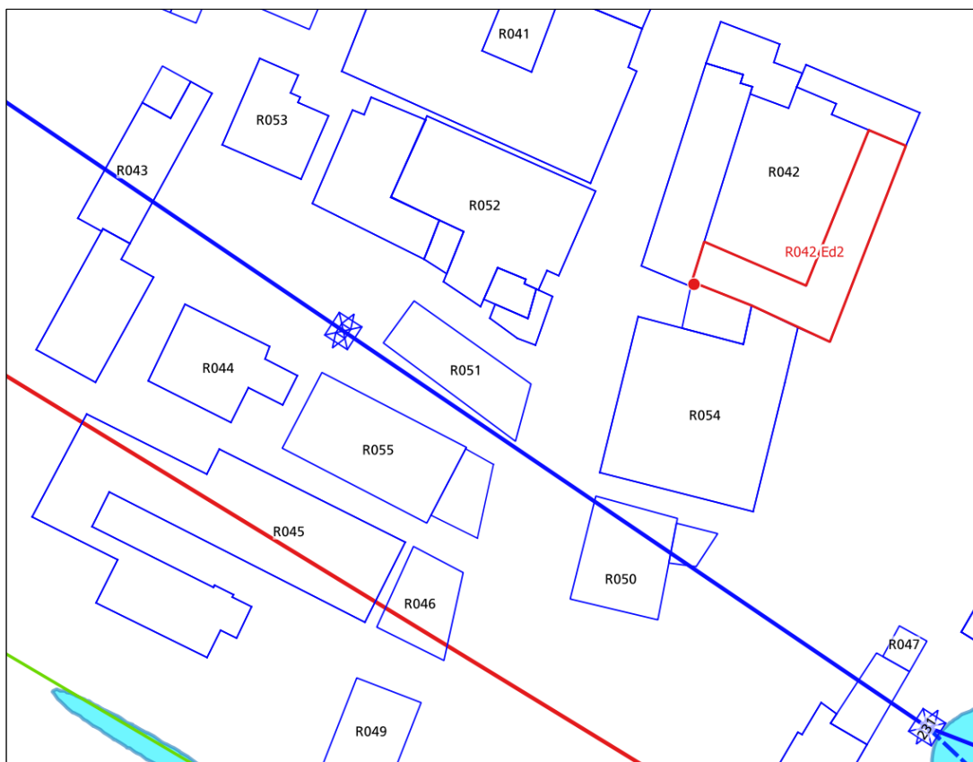
Figura 65: recettore ID 042 edificio 2 – scenario 1, curva isolivello dell'induzione magnetica a 3 \mu T alla quota di 57,5 m.
