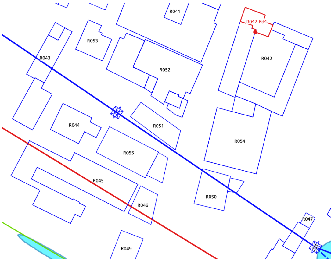
Figura 67: recettore ID 042 edificio 4 – scenario 1, curva isolivello dell'induzione magnetica a 3 \mu T alla quota di 57,5 m.
