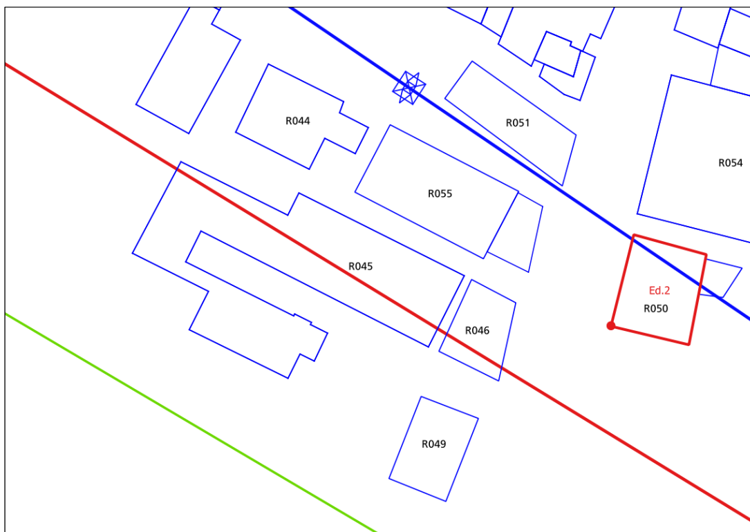
Figura 82: recettore ID 050 edificio 2 – scenario 4, curva isolivello dell'induzione magnetica a 3 \mu T alla quota di 57 m.
