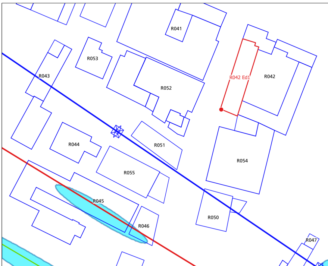
Figura 64: recettore ID 042 edificio 1 – scenario 1, curva isolivello dell'induzione magnetica a 3 \mu T alla quota di 61,5 m.
