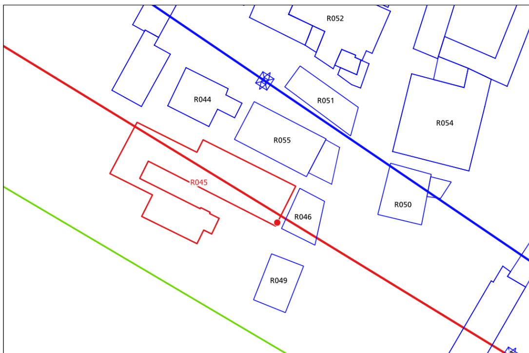
Figura 72: recettore ID 045 – scenario 1, curva isolivello dell'induzione magnetica a 3 \mu T alla quota di 55 m.
