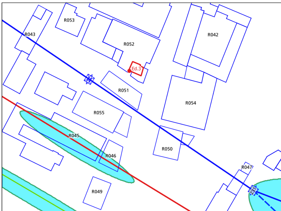
Figura 86: recettore ID 052 edificio 3 – scenario 1, curva isolivello dell'induzione magnetica a 3 \mu T alla quota di 62,5 m.
