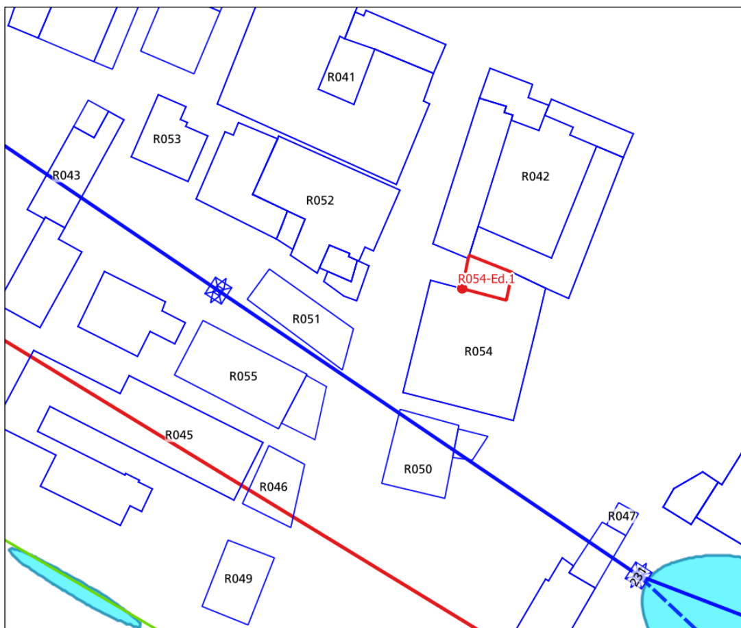
Figura 90: recettore ID 054 edificio 1 – scenario 1, curva isolivello dell'induzione magnetica a 3 \mu T alla quota di 57,5 m.
