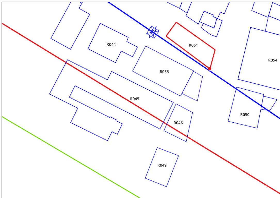
Figura 83: recettore ID 051 – scenario 4, curva isolivello dell'induzione magnetica a 3 \mu T alla quota di 57 m.
