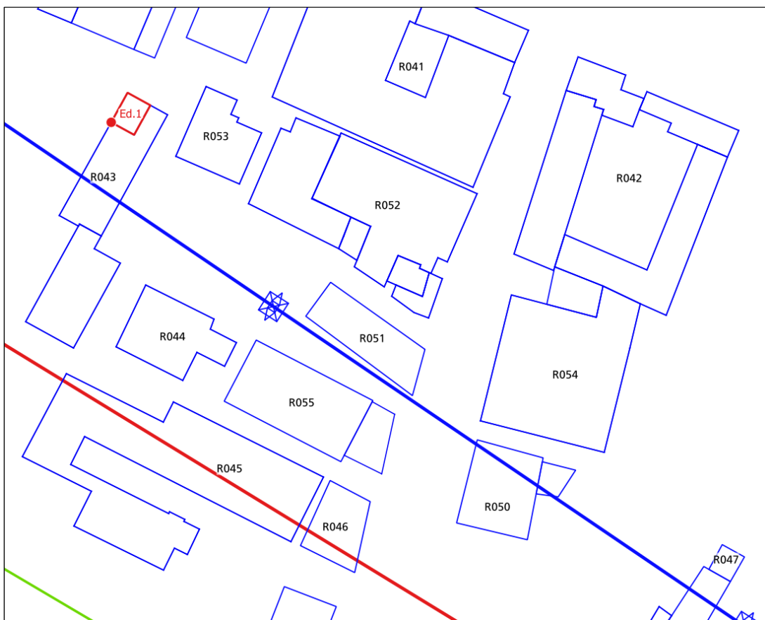
Figura 68: recettore ID 043 edificio 1 – scenario 1, curva isolivello dell'induzione magnetica a 3 \mu T alla quota di 57,5 m.
