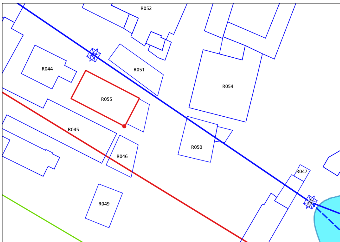
Figura 92: recettore ID 055 edificio 1 – scenario 4, curva isolivello dell'induzione magnetica a 3 \mu T alla quota di 56 m.
