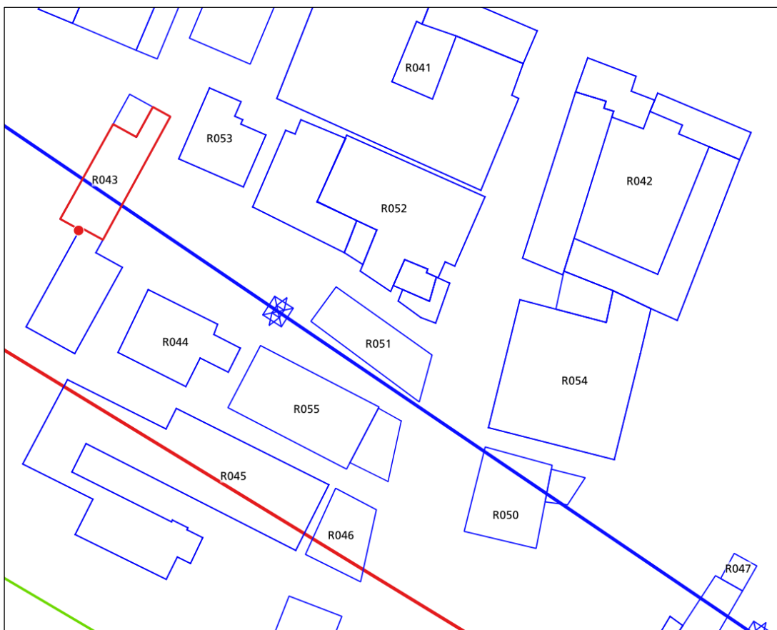
Figura 69: recettore ID 043 edificio 2 – scenario 4, curva isolivello dell'induzione magnetica a 3 \mu T alla quota di 56 m.
