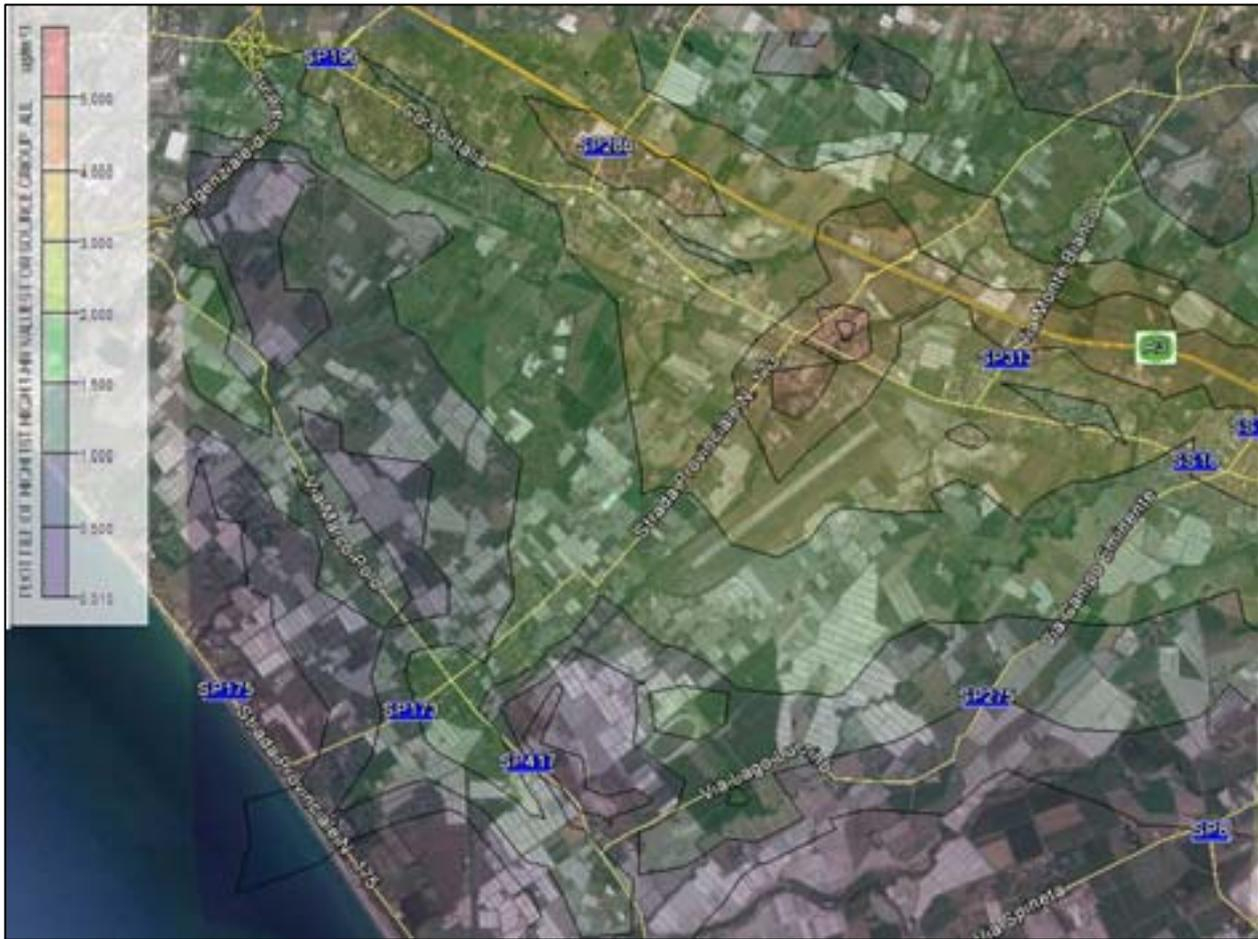
Figura 2-40 - Curve di isoconcentrazione da traffico indotto - PM10 ( $\mu\text{g}/\text{mc}$ )
