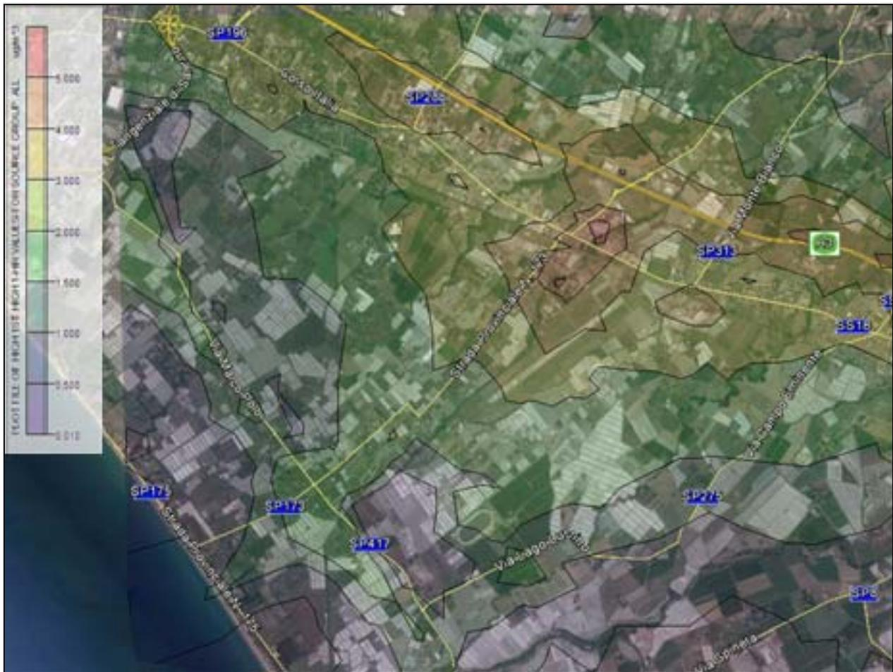
Figura 2-39 - Curve di isoconcentrazione da traffico indotto - NO2 ( $\mu\text{g}/\text{mc}$ )
