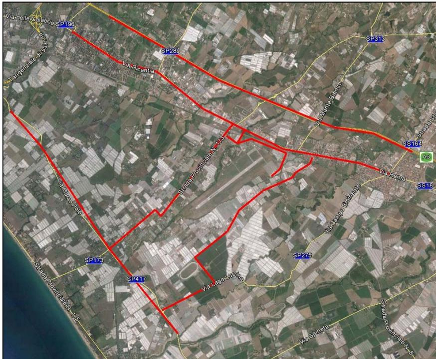
Figura 2-38 - Sorgenti stradali (in rosso) implementate nel modello di simulazione
