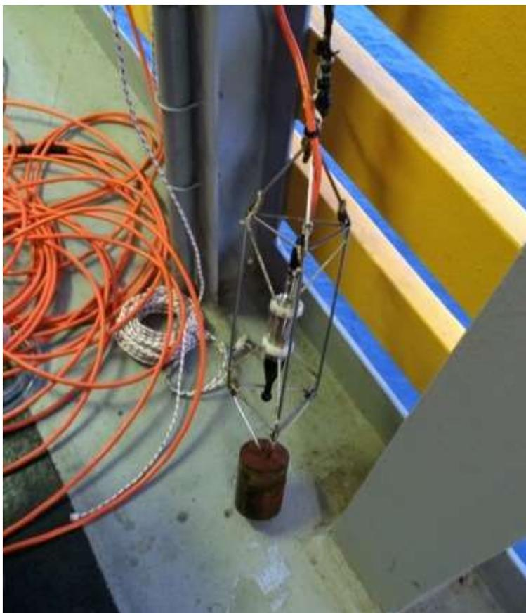
**Fig. 2.4.2.2.3 Idrofono con gabbia di protezione**
