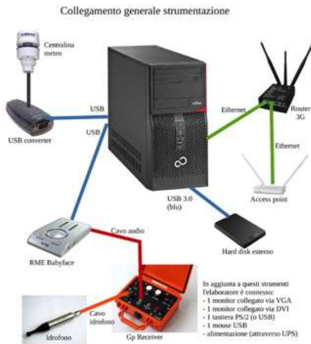
**Fig. 2.4.2.2.1 Schema del sistema acustico**
