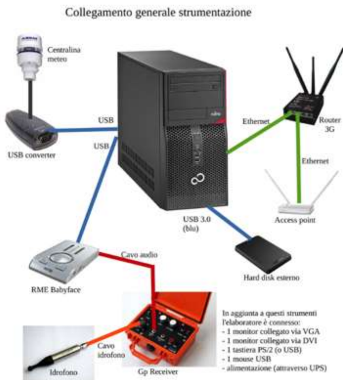
Fig. 2.4.2.2.1 Schema del sistema acustico
