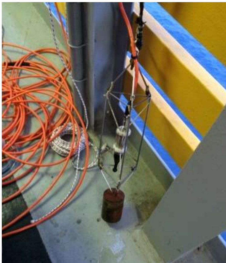
Fig. 2.4.2.2.3 Idrofono con gabbia di protezione
