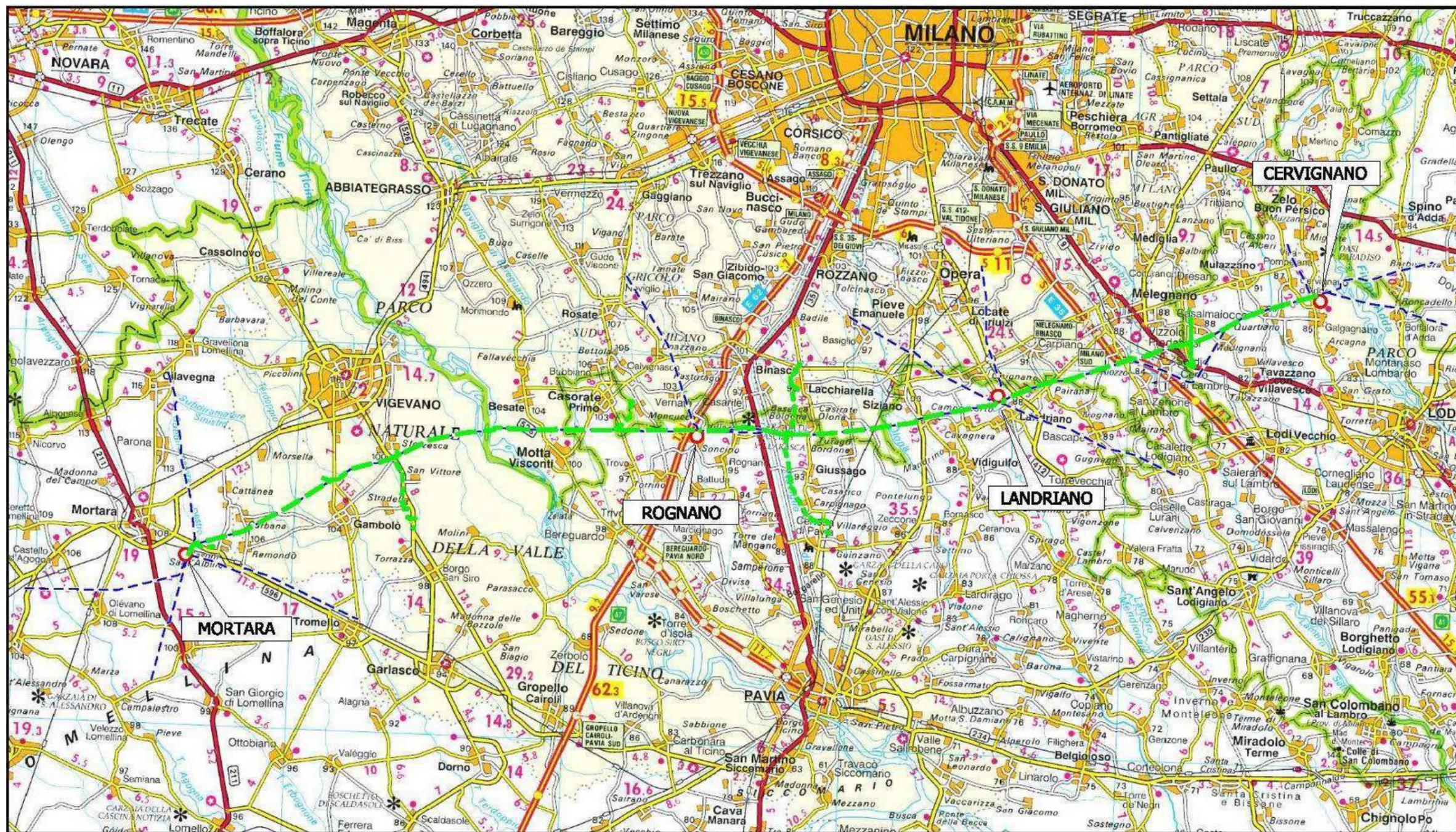
Fig. 1.2 - Inquadramento generale delle opere in dismissione identificate nello stralcio in colore verde (Met. Sergnano-Mortara, tratto Cervignano-Mortara DN 750 (30"), MOP 70 bar e opere connesse).
