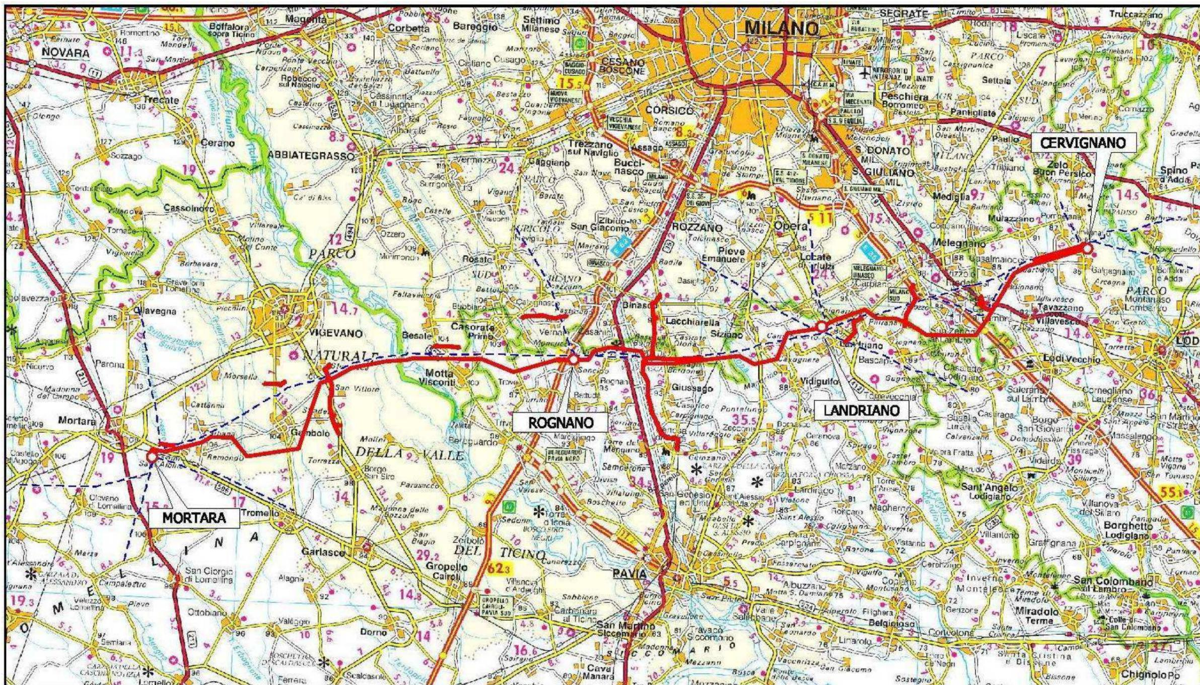
Fig. 1.1 - Inquadramento generale delle opere in progetto identificate nello stralcio in colore rosso (Met. Cervignano-Mortara DN 1400 (56"), DP 75 bar e opere connesse).
