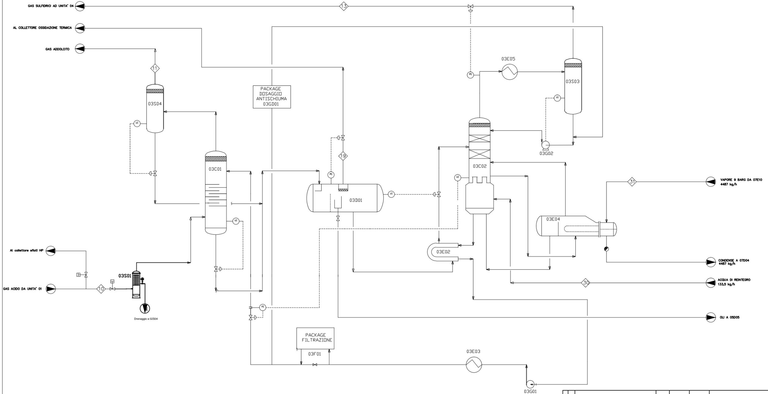
Package filtrazione include filtri a cartuccia e filtri a carbone attivo
