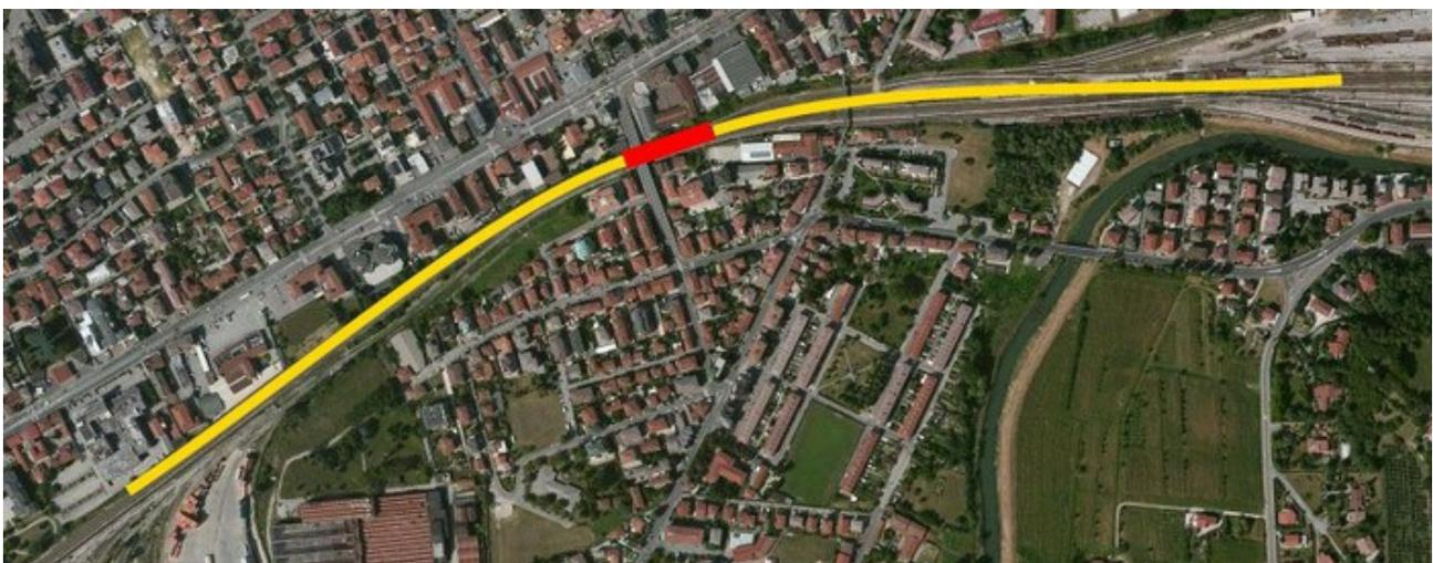
Posizione dello scavalco ed estensione delle rampe fino a quota 0.
