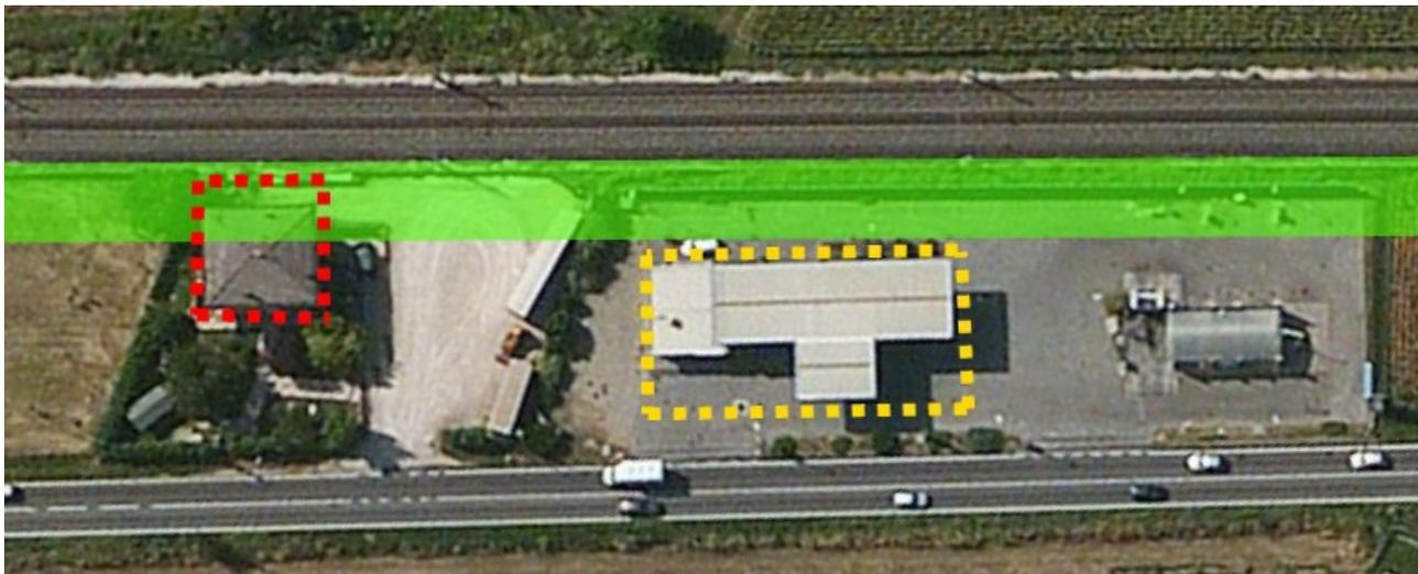
In questo caso un edificio residenziale è stato costruito a solo 5 metri dalla ferrovia, e si ha perfino un distributore di carburanti a 10 metri dalla linea. Le strutture principali del distributore possono essere conservate, ma occorre una verifica sulla disposizione degli impianti di stoccaggio sotterranei.
