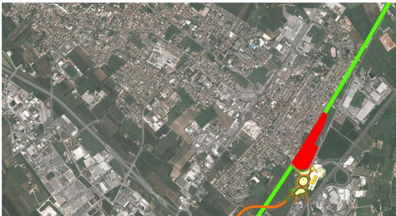
L'area individuata per la stazione, rispetto all'abitato di Montecchio e ai principali assi viari. Nell'immagine è stato inserito il progetto di modifica della viabilità attualmente in realizzazione.
