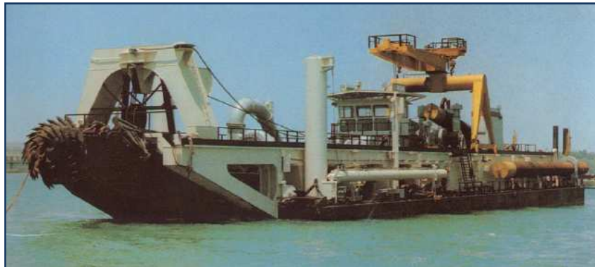
Figura 6-2 Draga aspirante refluyente con disgregatore
