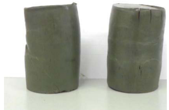
ROTTURA PROVINI TXUU
