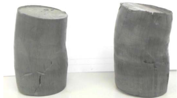
ROTTURA PROVINI TXUU
