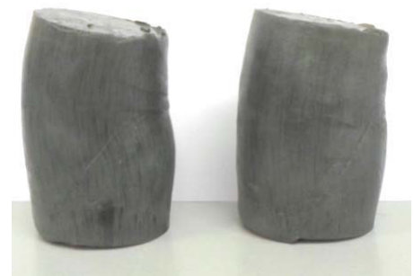
ROTTURA PROVINI TXUU
