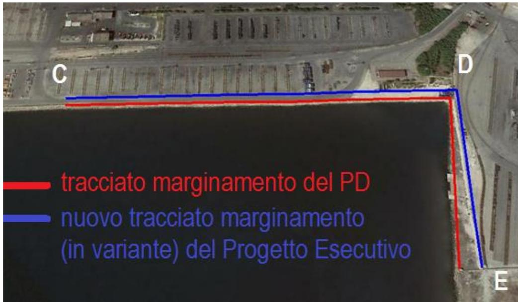
FIG. 5.3 – Planimetria del vecchio (PD) e nuovo (PE) tracciamento delle opere di marginamento a terra
