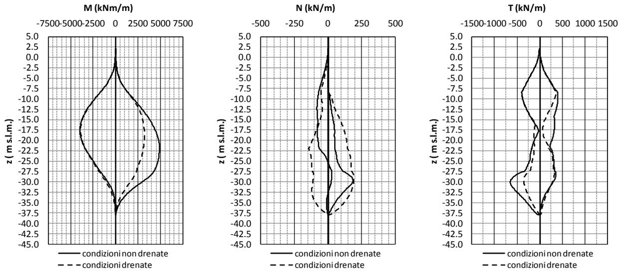
*Inviluppo delle caratteristiche della sollecitazione lungo il fusto dei monopali della sezione di studio n.5*
