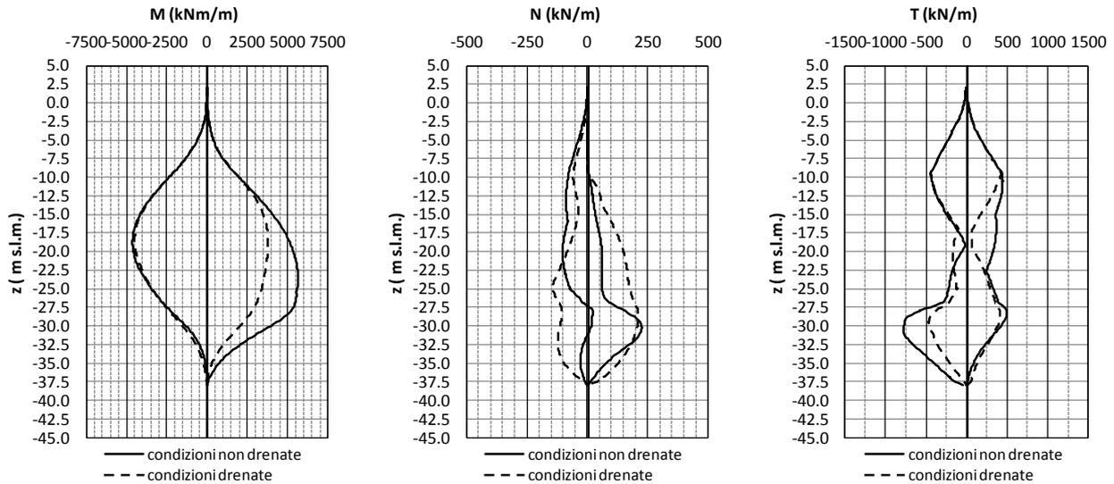
*Inviluppo delle caratteristiche della sollecitazione lungo il fusto dei monopali della sezione di studio n.7*
