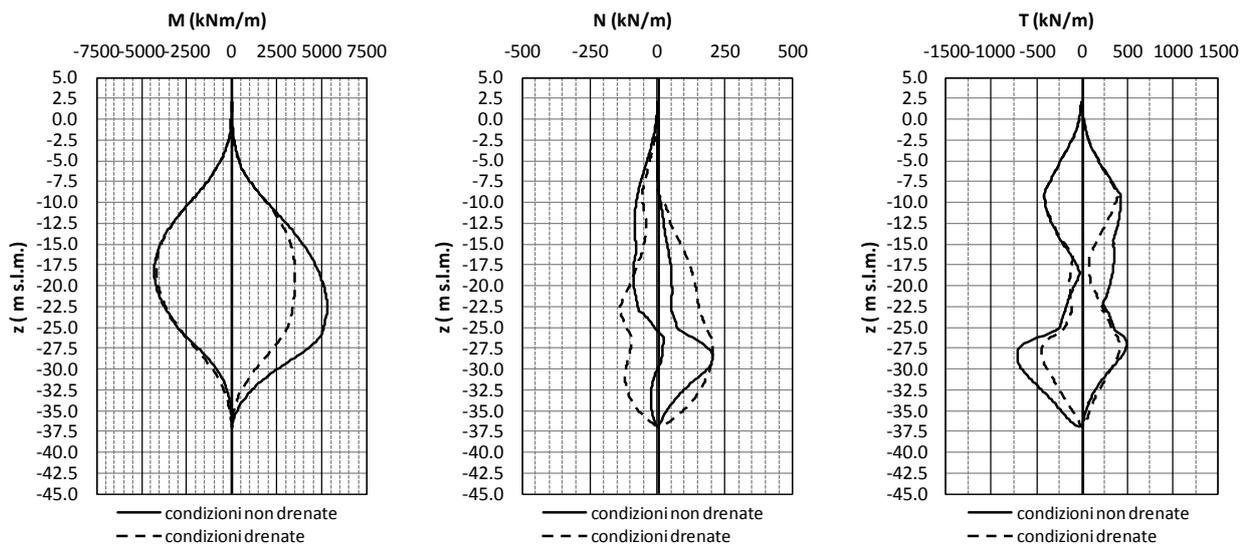
*Inviluppo delle caratteristiche della sollecitazione lungo il fusto dei monopali della sezione di studio n.8*
