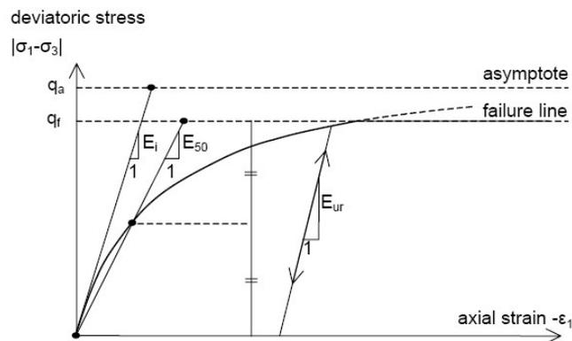
*Hardening Soil Model. Legame tensioni deformazioni in condizioni di primo carico e di scarico-ricarico*
