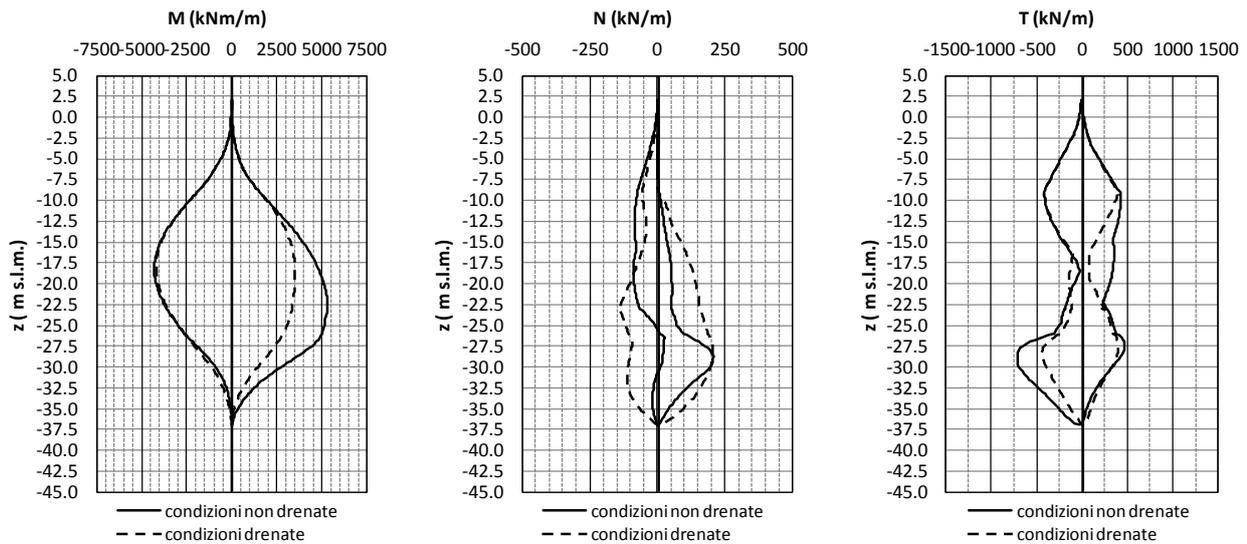
*Inviluppo delle caratteristiche della sollecitazione lungo il fusto dei monopali della sezione di studio n.6*
