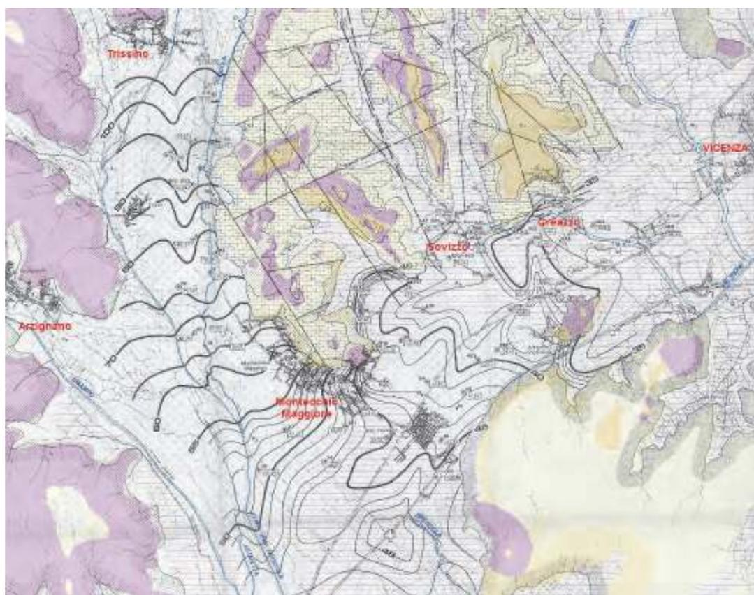
**Figura 6:** Rappresentazione delle isofreatiche (linee nere in grassetto) nella media e bassa valle dell'Agno nel settembre 1978 estratte dallo studio IRSEV citato in precedenza con base la carta geologica regionale. Tale rappresentazione, elaborata utilizzando una fitta rete di pozzi di controllo opportunamente livellati, fornisce fondamentali indicazioni circa la dinamica del deflusso idrico sotterraneo dell'area e in particolare sulle direttrici preferenziali di deflusso.
