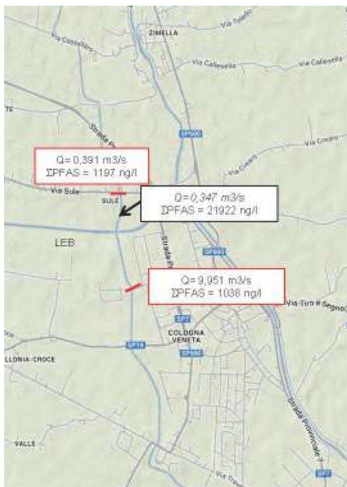
Figura 13: Risultati delle misure nel tratto interessato dallo scarico ARICA.
