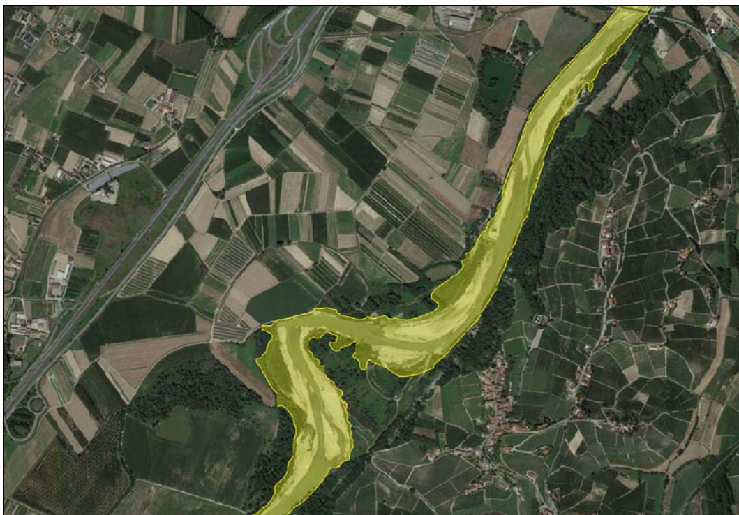
Fig. 3.e.3. Area di esondazione relativa alla situazione di progetto con sbarramento alzato con portata pari a 570 m 3 /s (portata massima contenuta all'interno dell'alveo inciso).
