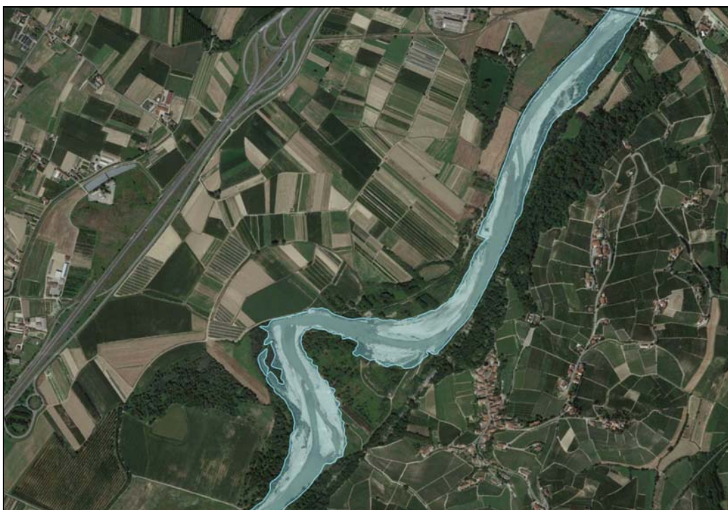
Fig. 3.e.1. Area di esondazione del F. Tanaro relativa alla situazione attuale con traversa rotta con portata pari a 710 \text{ m}^3/\text{s} (portata massima contenuta all'interno dell'alveo inciso).
