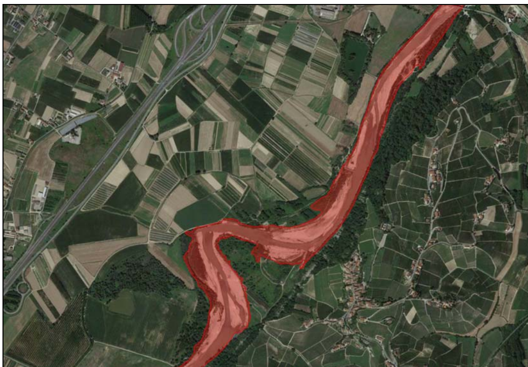
Fig. 3.e.2. Area di esondazione relativa alla situazione ante crollo (coincidente con scenario di progetto con sbarramento abbattuto) con portata di 650 \text{ m}^3/\text{s} (portata massima contenuta all'interno dell'alveo inciso).
