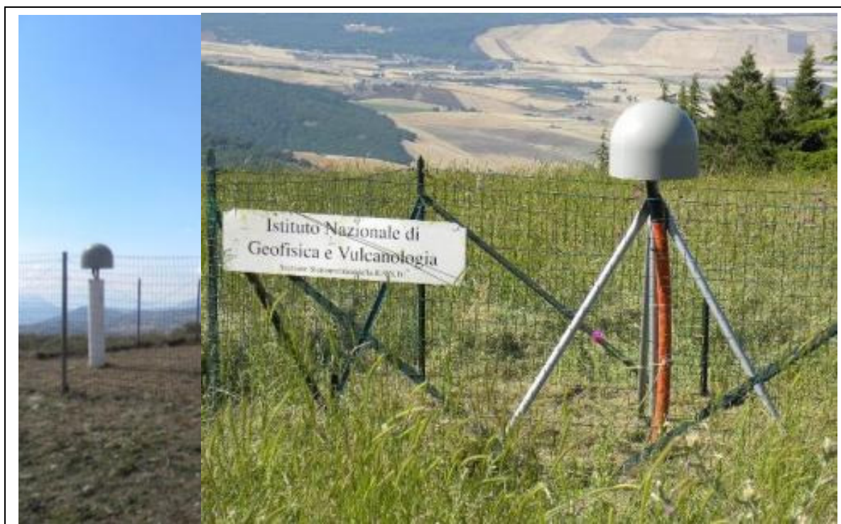
Figura C2.4: Esempi di monumentazione geodetica per GPS a doppia frequenza, a sinistra su pilastrino di cemento armato, a destra su tripode in acciaio ancorato al suolo.
