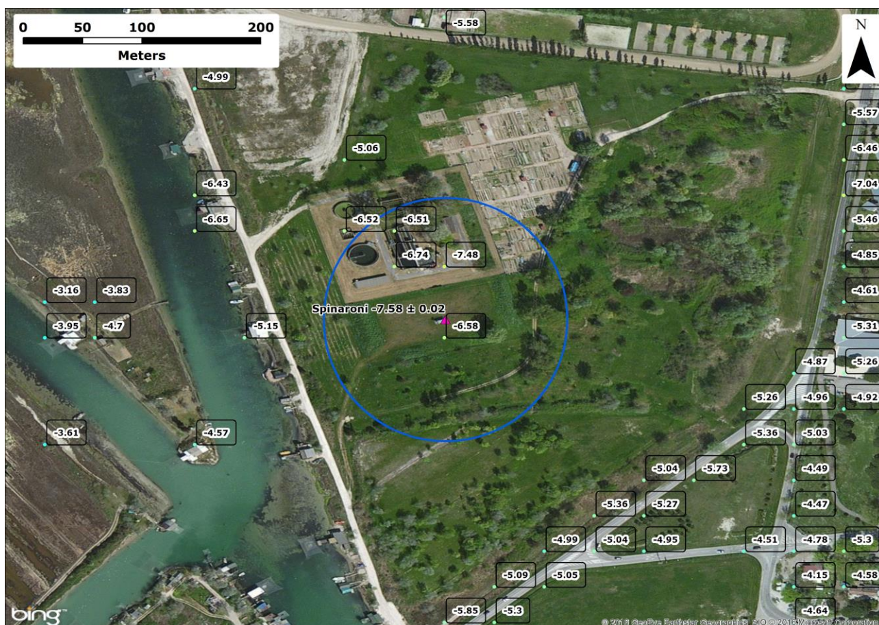
Fig. 48 - Confronto delle velocità calibrate (rettangoli trasparenti, calibrazione effettuata con il CGPS di Smarlacca) con il CGPS di Spinaroni.
