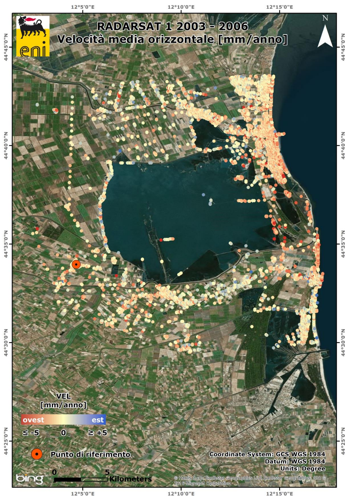
Fig. 13 - Velocità medie annue per la componente ORIZZONTALE (est-ovest), ottenuta dalla combinazione dei dati RSATI in doppia geometria, per il periodo 2003 – 2006.
