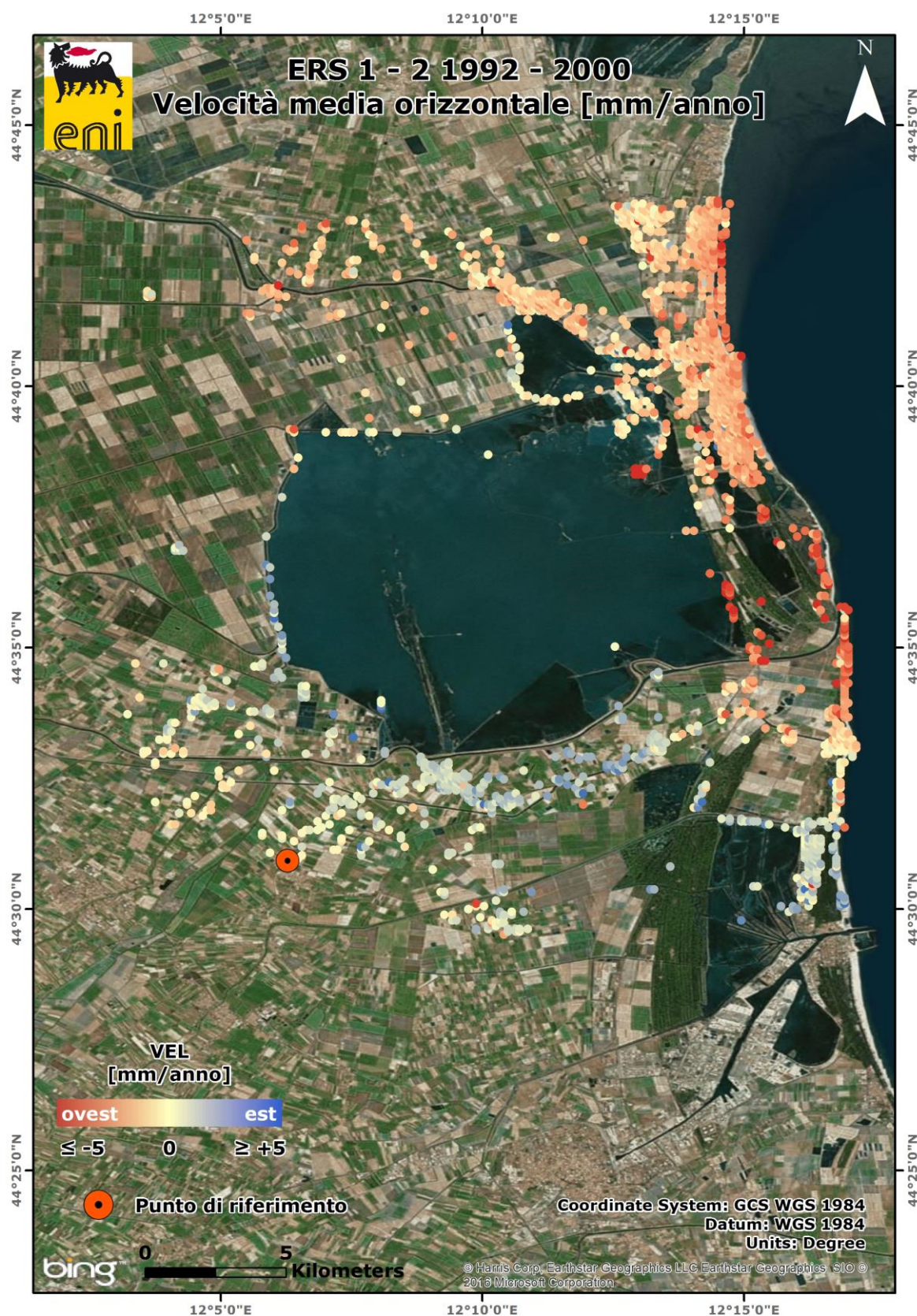
Fig. 9 - Velocità medie annue per la componente EST-OVEST calcolata dalla combinazione dei dati ERS 1-2 per il periodo 1992 – 2000.
