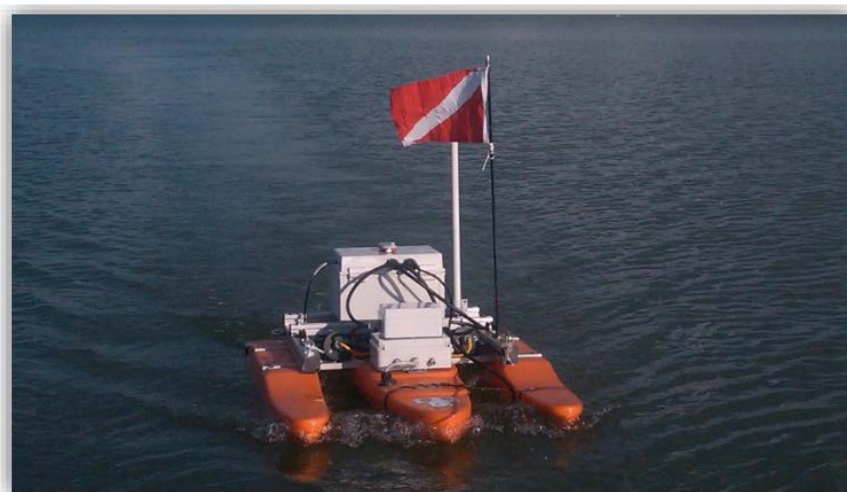
Figura 3-9 Rilievi batimetrici 2014 – Il mezzo autonomo di superficie impiegato per il rilievo delle porzioni di Valle caratterizzate da profondità particolarmente modeste.
