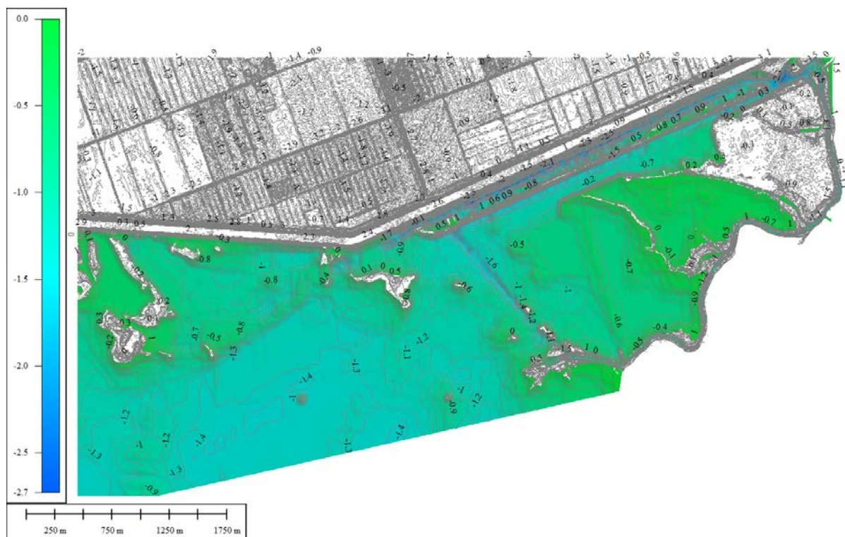
Figura 3-15. Rilievi batimetrici 2014 - Mappa dell'integrazione dei dati batimetrici con i dati LIDAR, sono rappresentate le curve di livello ogni 0.1m
