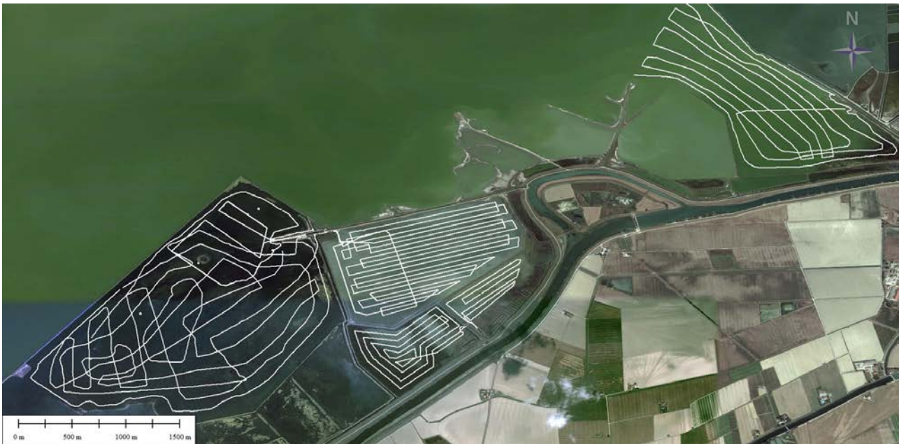
Figura 3-20. Rilievo 2016 - Linee di navigazione coincidenti con i profili ecografici eseguiti durante la campagna
