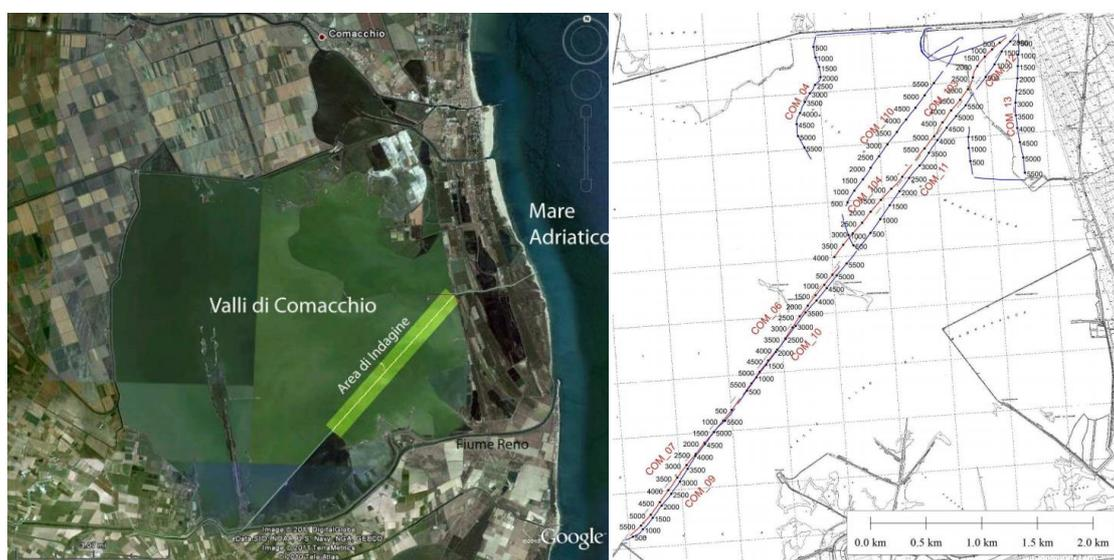
Figura 37. Campagna di misura della riflettività del fondale. A sx corografia dell'area indagata. A dx linee di navigazione ed acquisizione dati.
