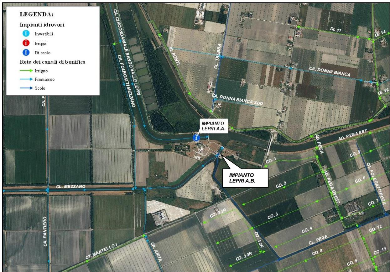
Figura 28 Impianto idrovoro Valle Lepri Acque Alte e Acque Basse e schema dei canali afferenti
