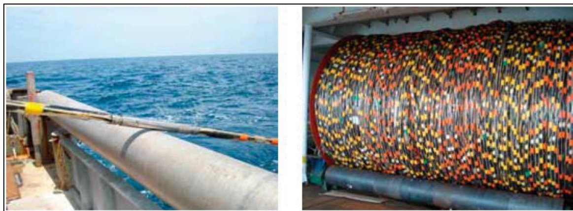
Figura 11 Esempio di Cavo Sismico o Streamer (OGP, 2011)
