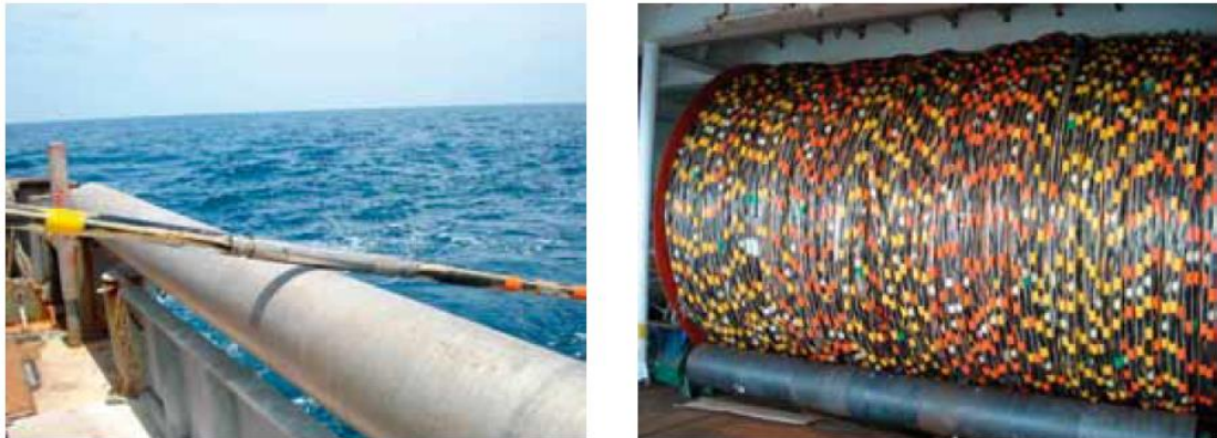
Figura 6.5: Esempio di Cavo Sismico o Streamer (OGP, 2011)
