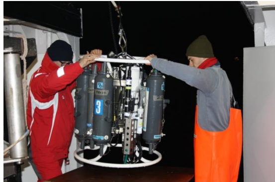
CTD: Sea Bird Electronics SBE19plusV2 (frequenza di campionamento 24 Hz) dotato dei seguenti sensori:
