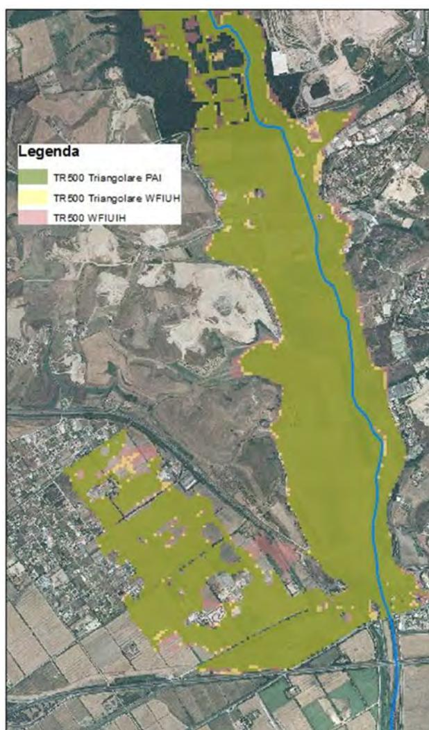
Figura 57 Comparazione aree inondabili per Tr 500 in prossimità della confluenza con il fiume Tevere
