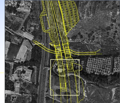
L'imbocco nord risulta essere spostato rispetto alla posizione dell'imbocco ipotizzato nel progetto definitivo oggetto di VIA
