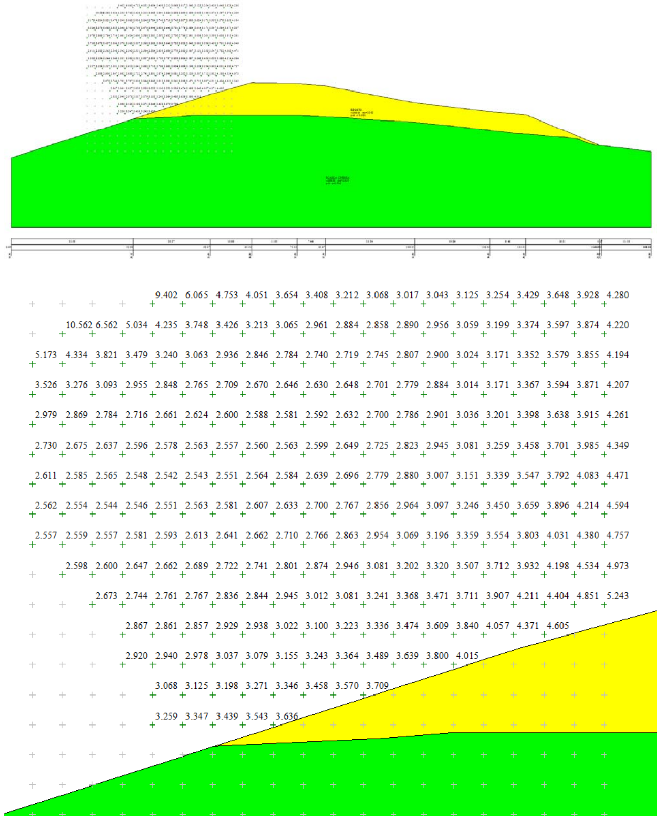
Matrice dei centri con coefficienti di sicurezza (tutti i valori sono riportati nel fascicolo di calcolo di stabilità della relazione geotecnica).
