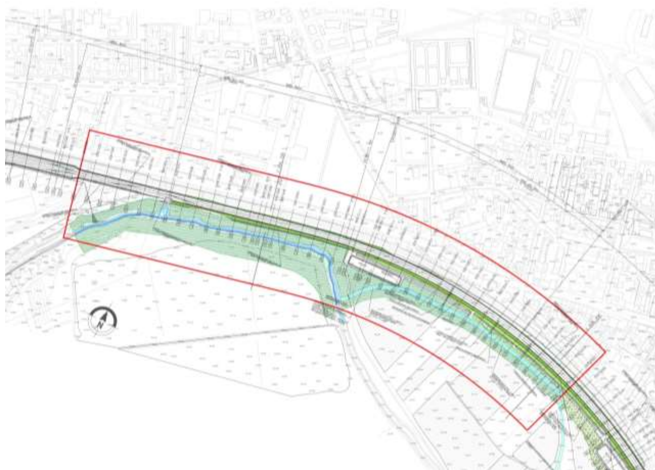
Fig. 2-7: Interventi di mitigazione e compensazione - Area Critica 1 /CORRIDOIO ECOLOGICO VERONA SUD (Rif. Elab. PLANIMETRIA MITIGAZIONI OPERE A VERDE TAV. 1/14 scala 1:2.000 IN0D1DI2P6IA0000001C)
