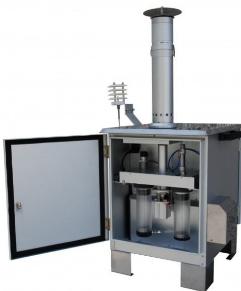
Figura5.1 - SkypostHv utilizzato per il monitoraggio delle polveri
