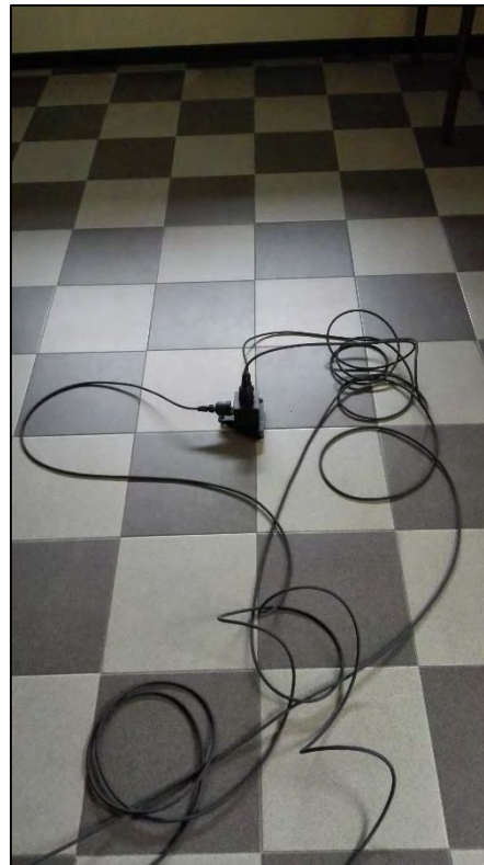
Posizionamento accelerometro triassiale, 1° piano f.t.
