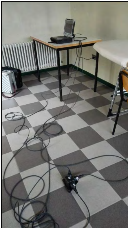
Posizionamento accelerometro triassiale, 1° piano f.t.
