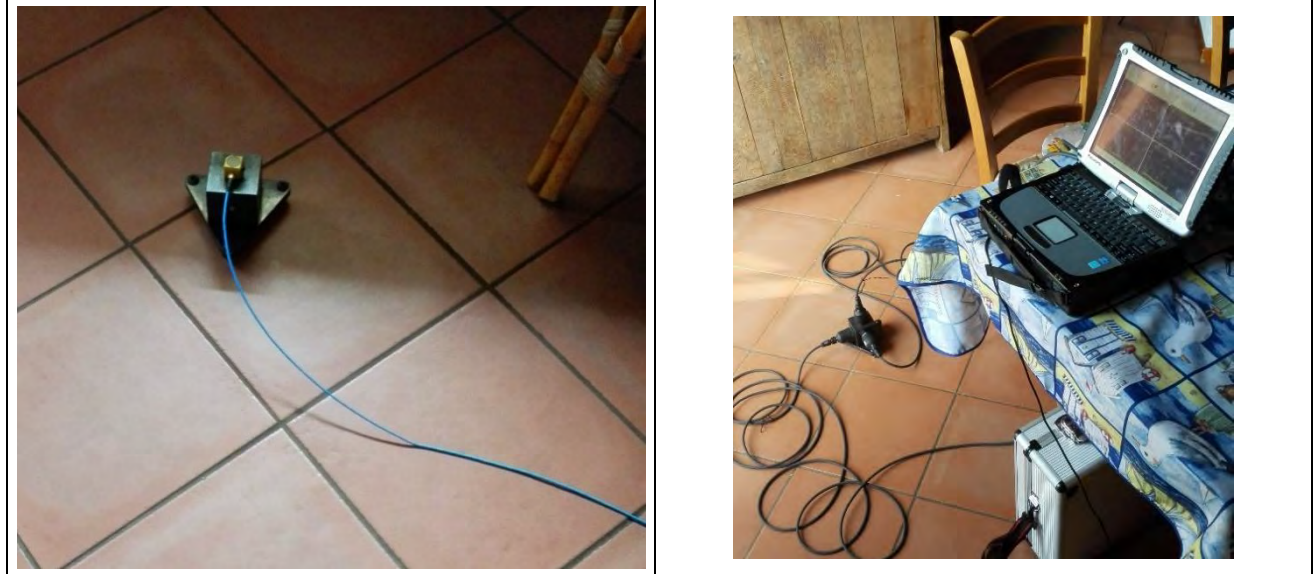
Posizionamento accelerometro triassiale, 1° piano f.t. Posizionamento accelerometri monoassiali, 2° piano f.t.
