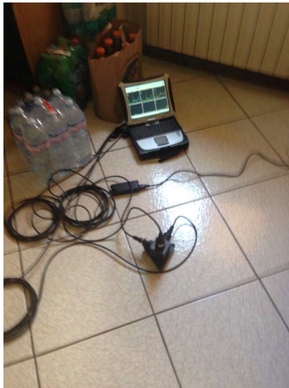
Posizionamento accelerometri monoassiali, 1° piano f.t.
