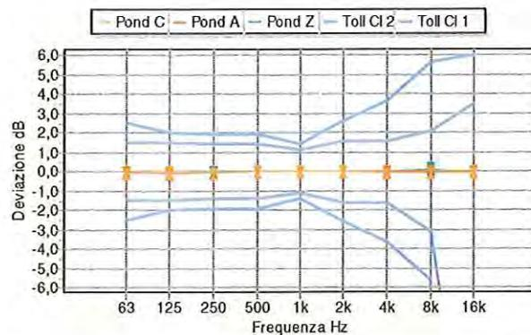
**PR 1A-7 - Ponderazione di Frequenza e Temporalità a 1 kHz**
