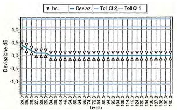
**PR 1A-9 - Linearità di livello comprendente il selettore del campo di misura**
