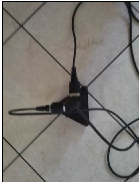
Posizionamento accelerometro triassiale, 1° piano f.t.
