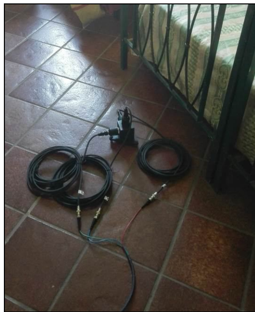
Posizionamento accelerometro triassiale, 3° piano f.t.
