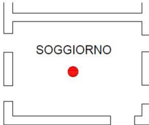
Posizionamento accelerometro triassiale, 1° piano f.t.
