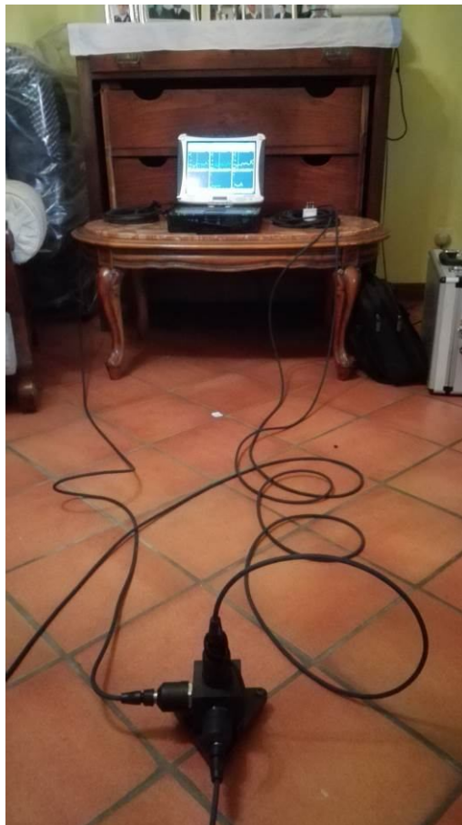
Posizionamento accelerometro triassiale, 1° piano f.t.
