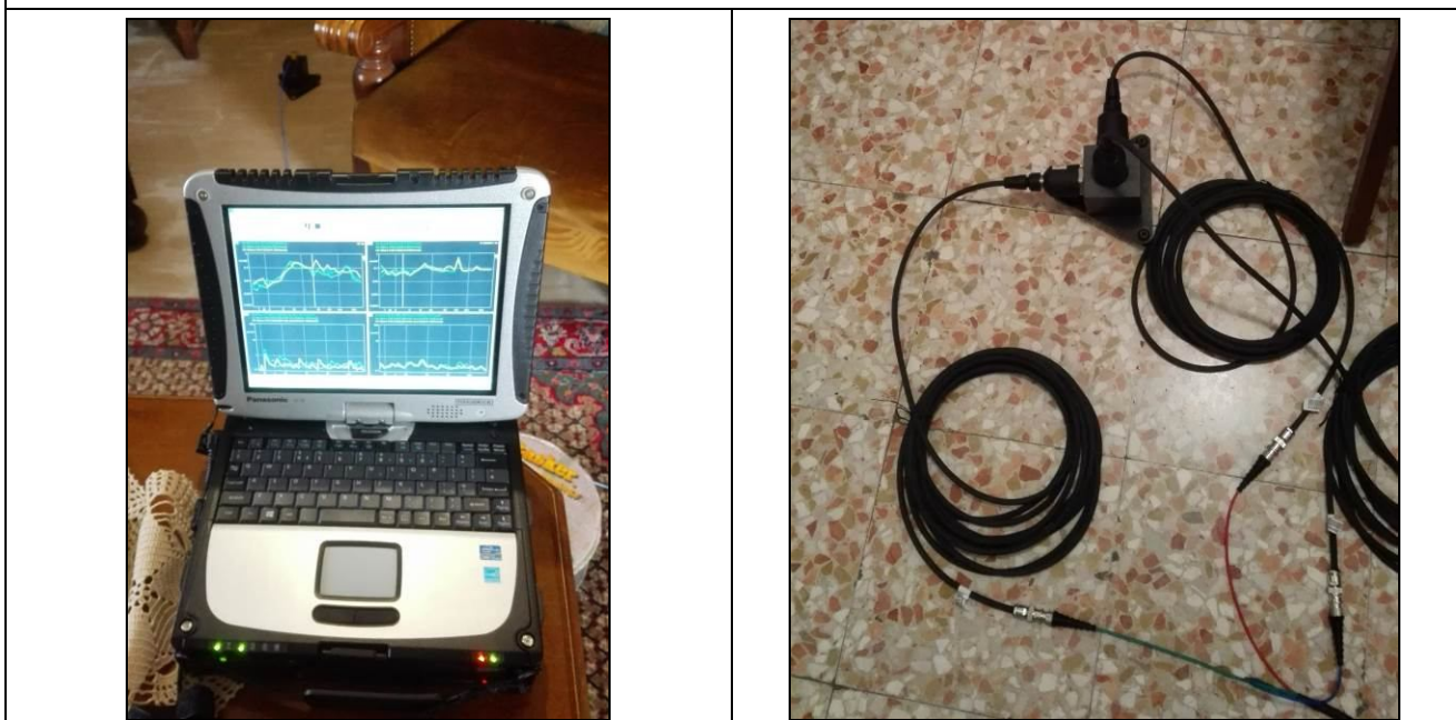
Posizionamento accelerometro triassiale, 1° piano f.t.
