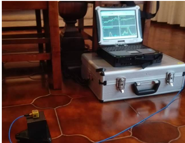
Posizionamento accelerometro triassiale, 1° piano f.t.
