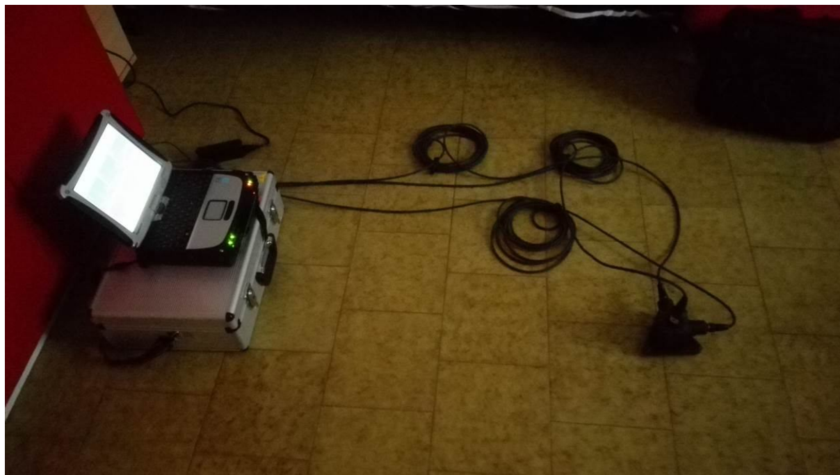
Posizionamento accelerometro triassiale, 2° piano f.t.
