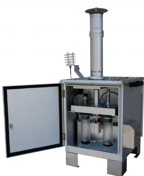
Figura 5.1 - Skypost Hv utilizzato per il monitoraggio delle polveri
