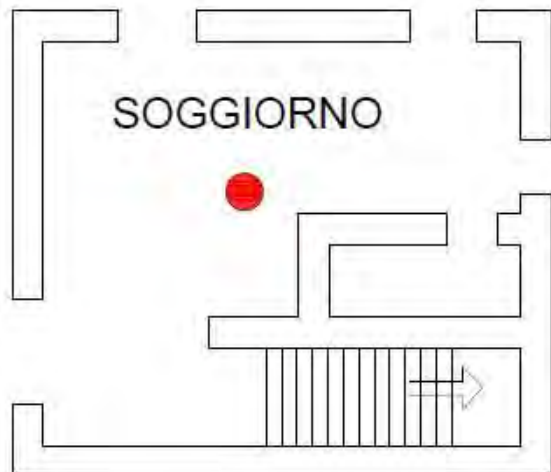
Posizionamento accelerometro triassiale, 1° piano f.t.
