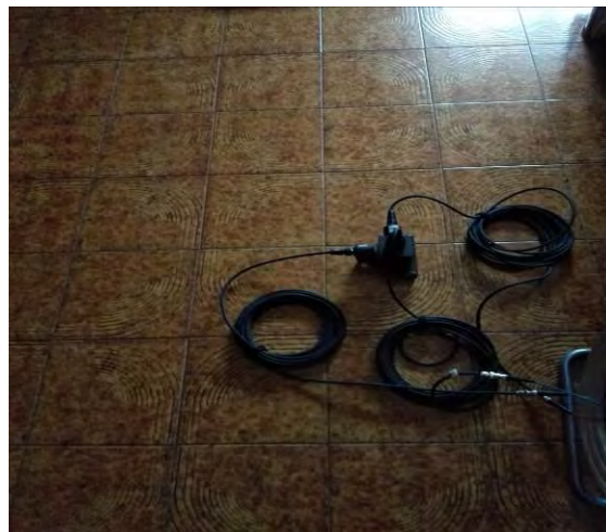
Posizionamento terna monoassiale, 2° piano f.t.
