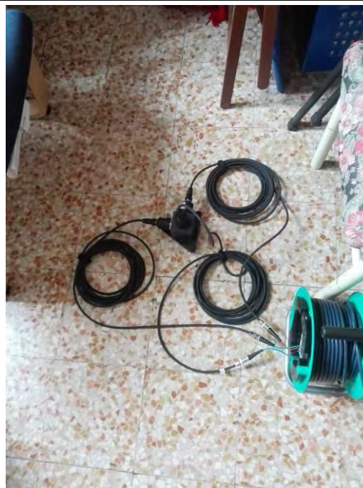
Posizionamento accelerometri monoassiali, 2° piano f.t.
