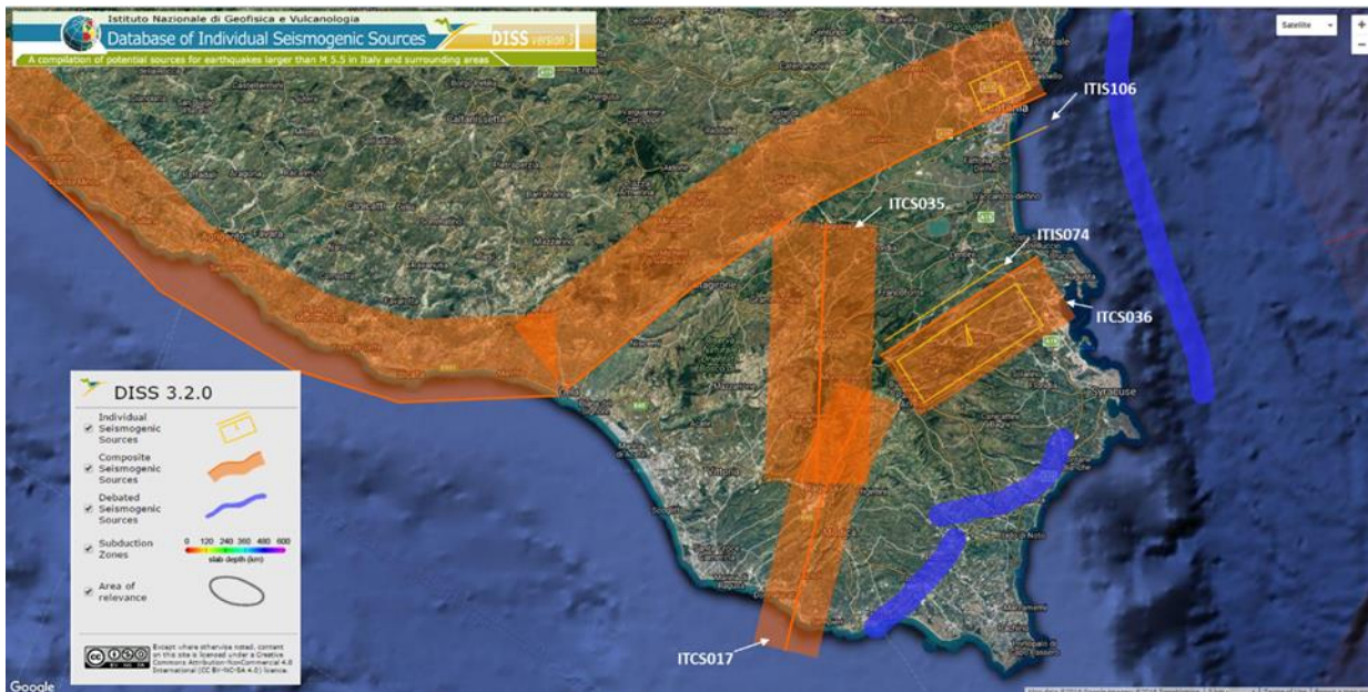
Fig. 21: mappa delle faglie sismogenetiche estratta dal DISS. I rettangoli gialli sono le proiezioni in superficie delle sorgenti sismogenetiche individuali; in figura è indicata la faglia di Monte Lauro (codice DISS ITIS074) e la faglia di Gravina di Catania (codice DISS ITIS106). Le fasce arancioni sono invece le proiezioni delle sorgenti sismogenetiche composite; in figura sono indicate le faglie di Scicli-Giarratana (codice DISS ITCS017), di Ragusa-Palagonia (codice DISS IRCS035) e la faglia di Monte Lauro (ISCS036). In viola le faglie “dibattute”.
