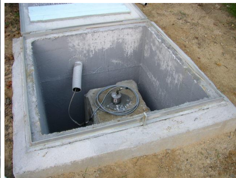
Fig. 31: esempio di alloggiamento della strumentazione nell'armadietto e del sensore all'interno del pozzetto.
