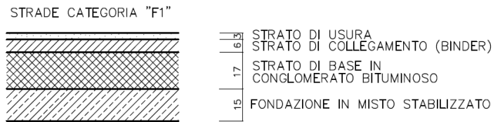
Figura 203 – Dettaglio della sovrastruttura stradale
