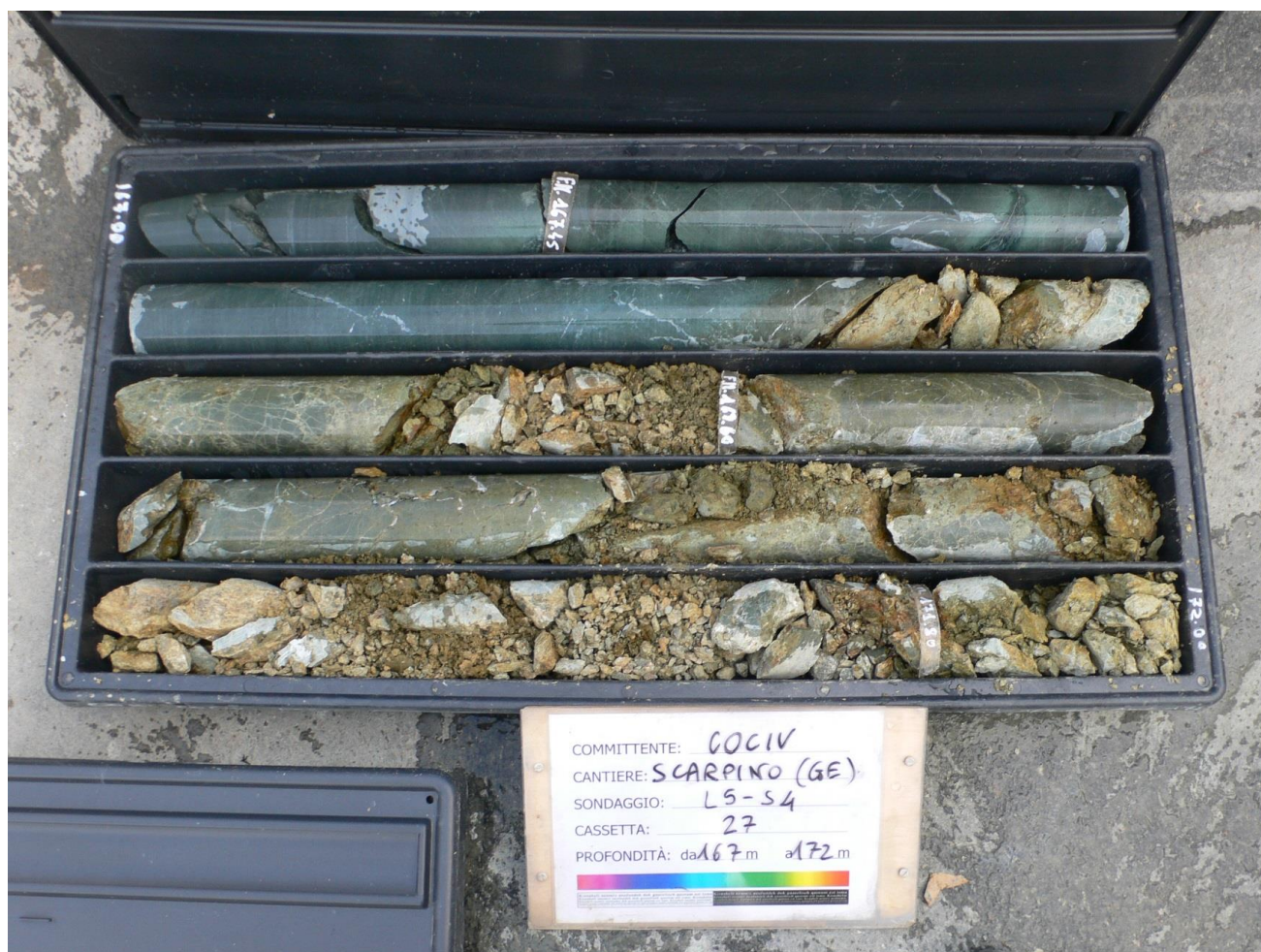
Figura 3. Sondaggio L5-S04 – cassetta 27, esempio di settore interessato da strutture disgiuntive all'interno dei Metabasalti del M. Figogna (B').
