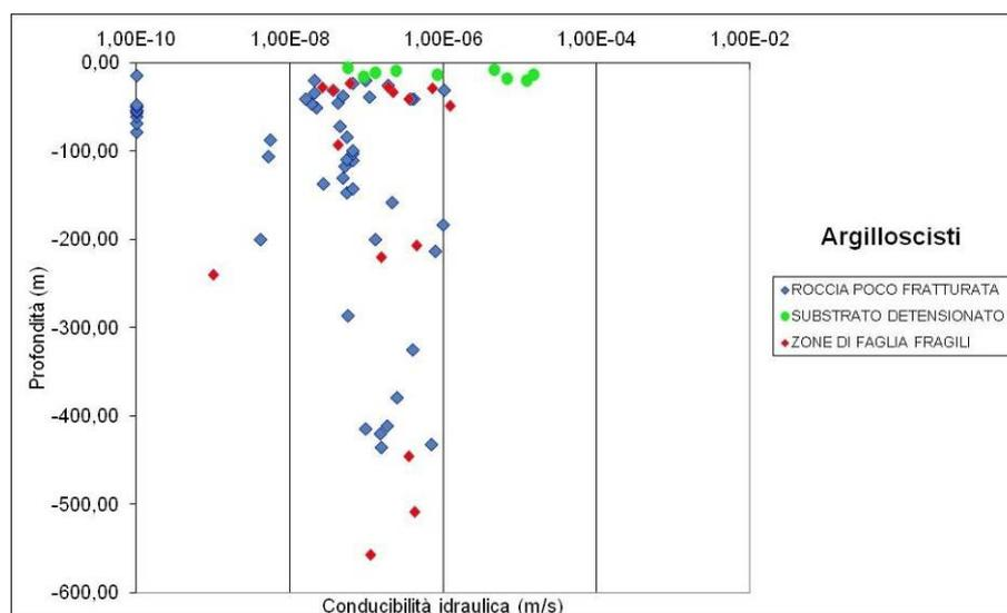
**Figura 6 - Grafico delle conducibilità idrauliche per gli argillocisti da prove in foro di sondaggi del Progetto Preliminare, Definitivo ed Esecutivo. Sono state distinte prove eseguite in roccia poco fratturata, substrato detensionato e zone di faglia.**
