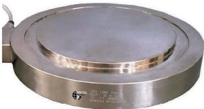
La cella di carico tipo è costituita da un corpo in acciaio inossidabile sensibilizzato da una serie di griglie estensimetriche (strain-gauges) applicate alla superficie interna del corpo stesso e isolate.
