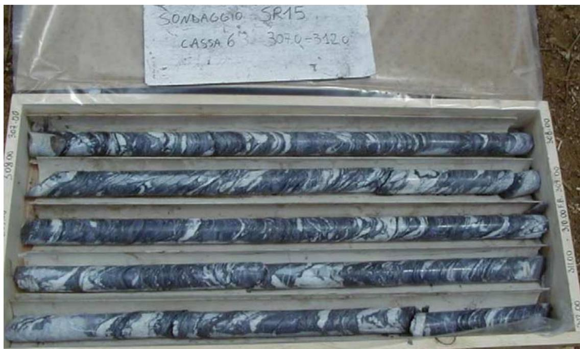
**Figura 14. Argille a palombini del Passo della Bocchetta (aP), Sondaggio SR15.**
