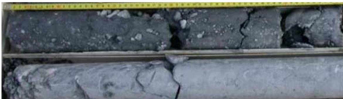
**Figura 17. Sondaggio SR15, esempio di come si presentano le Argille a Palombini del Passo della Bocchetta in condizioni indisturbate (in basso) e quando sono attraversate da una faglia (in alto, gouge sviluppato a spese di argille/argillocisti).**
