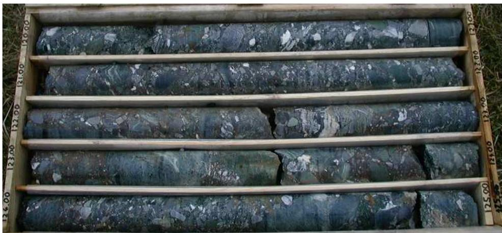
Figura 6. Sondaggio AA301G115, Formazione di Molare, litofacies ruditica poligenica (FMp) (cf. "Membro conglomeratico parzialmente cementato o non cementato - Progetto Definitivo").
