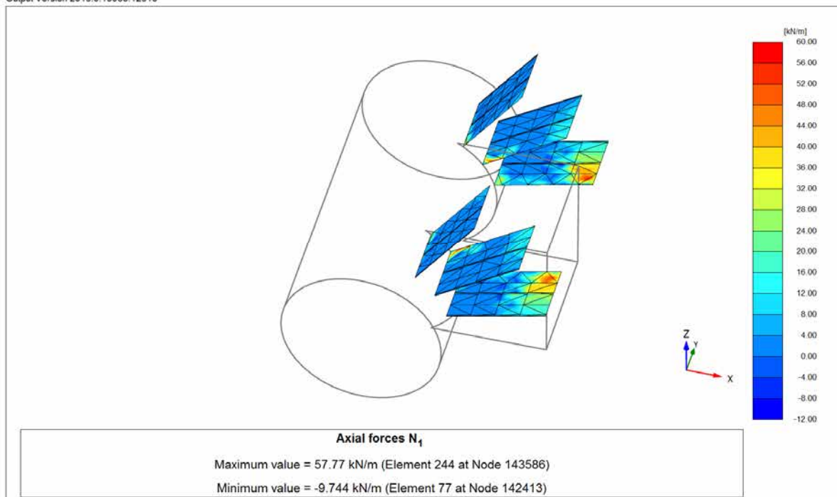
Figura 67 Azione assiale N_1 [kN/m] (Fase 9)
