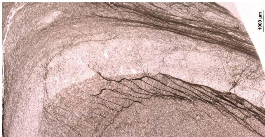
**Figura 8 - Argilloscisto costituito da alternanze di livelli alternativamente più ricchi in fillosilicati o in quarzo, che definiscono una foliazione principale (S1±S2) deformata da pieghe aperte D3, con sviluppo di *pressure solution cleavage* di piano assiale.**
