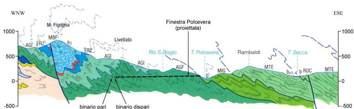
Figura 3 – Stralcio del profilo geologico BB’ attraverso la Val Polcevera e la dorsale del M. Figogna, estratto dal Foglio CARG “Genova” (cfr. Figura 1 e Errata. L’origine riferimento non è stata trovata.). Il profilo si colloca in corrispondenza della pk 4+764 (binario pari). È riportata la traccia della Finestra Polcevera, ubicata circa 1 km a N dell’area di interesse (cfr. Figura 1), ma comunque utile per comprendere i rapporti strutturali tra le varie unità. Per la legenda litologica (sigle) si veda la Tabella 1.
