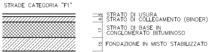
Figura 4 – Dettaglio della sovrastruttura stradale
