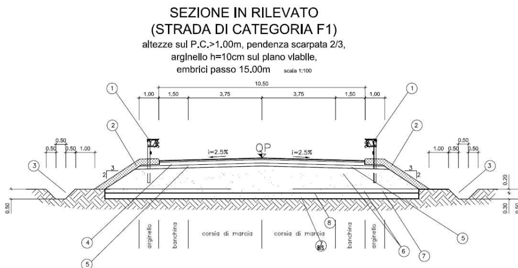
Figura 3 – sezione tipo in rilevato
