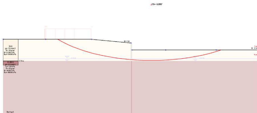
Figura 33 – Analisi di stabilità globale in condizioni statiche, sezione 2 (H di scavo 3.0m). FS=4.0
