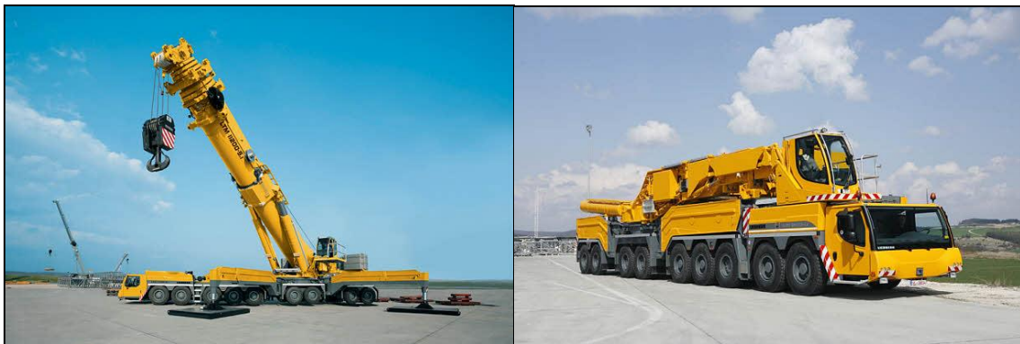
Figura 13 Tipologia dei mezzi proposti per il varo delle travare (indicativo)
